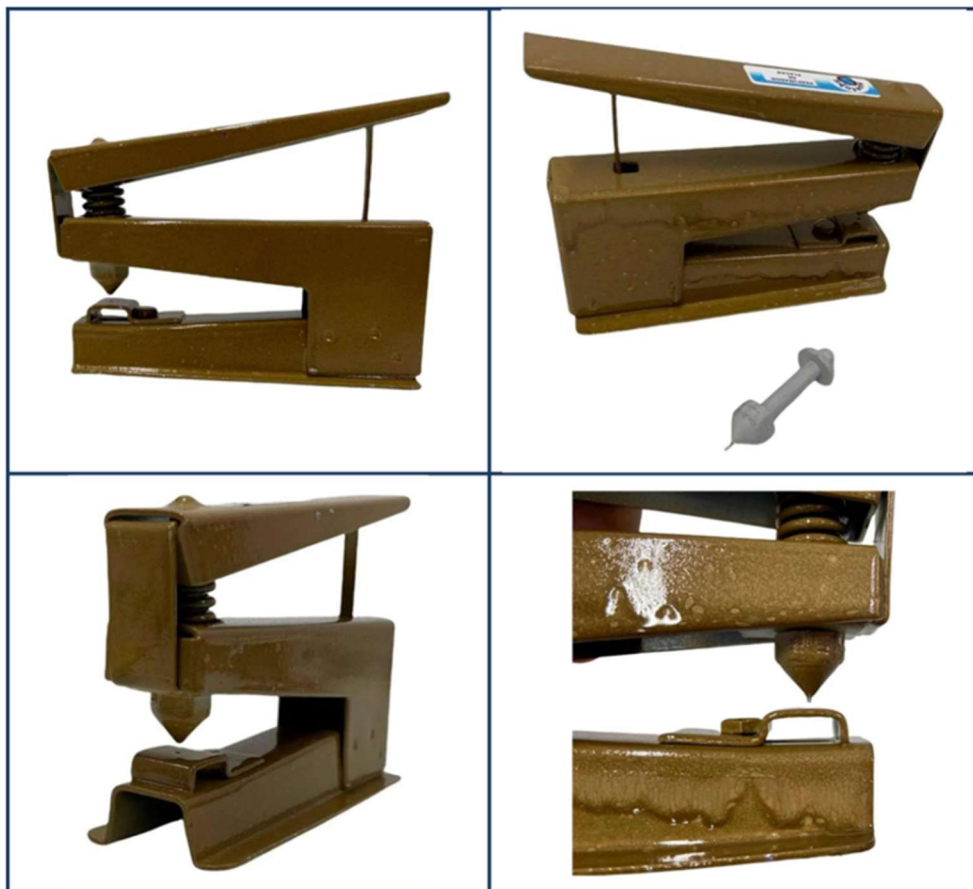
Figura 06-A – Aspecto físico do furador manual tipo “grampeador”
