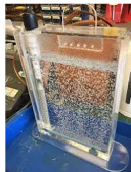
Figura 02 – Versões comerciais de tanques de corrosão e versão caseira feito em acrílico. Note que a corrosão da placa é feita na vertical.
