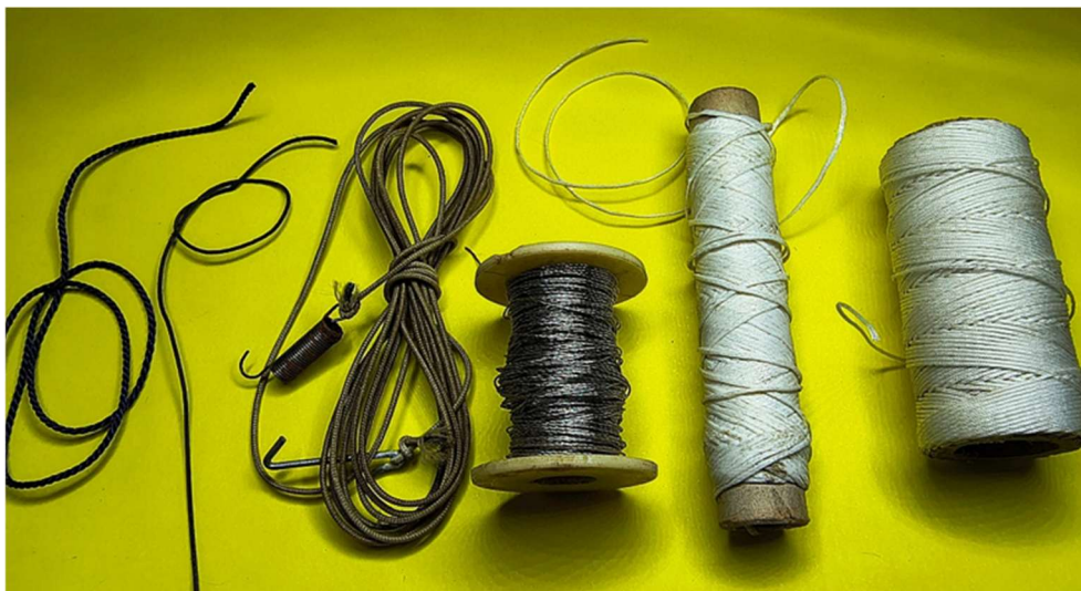
Figura 5. Alguns tipos de “cordinhas de dial” tradicionais, de poliamida (náilon) e poliéster. No carretel do centro está um cabinho de fio fino de aço trançado, que também foi empregado nos mostradores de rádios antigos. Nos rádios antigos, valvulados, frequentemente o cordão era nas cores preto ou marrom. Nos rádios transistorizados os fabricantes passaram a adotar predominantemente cordões de cor branca.
