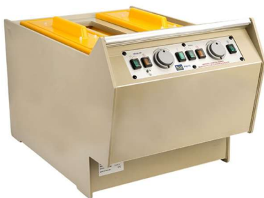
Figura 02 – Versões comerciais de tanques de corrosão e versão caseira feito em acrílico. Note que a corrosão da placa é feita na vertical.
