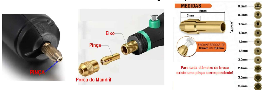
Figura 09 – Sistema de pinças utilizadas nas mini drills e também, originalmente nas micro retíficas.
