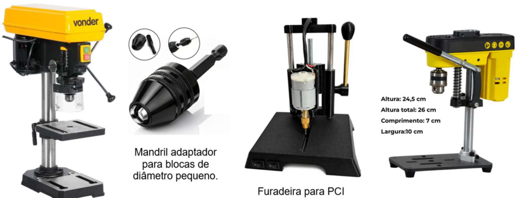
Figura 12 – Furadeira de bancada convencional – o mandril adaptador e furadeiras para placas de circuito impresso (PCI).
