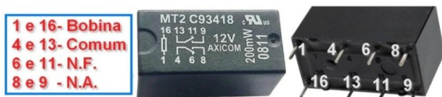
Figura 03 – Pinagem do relé utilizado - (relé de 8 pinos)
