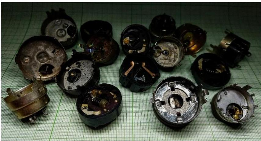
**Figura 10.** Chaves de potenciômetros com defeito — uma ocorrência cada vez mais comum — que tiveram que ser substituídas. O mecanismo parece perfeito, com o “clíc” característico, mas os contatos apresentavam carbonizações. Muitas evidenciam tentativas de “limpezas” através de sprays penetrantes. Tais chaves costumam apresentar desgaste elevado por atuarem diretamente nas tensões da rede.
