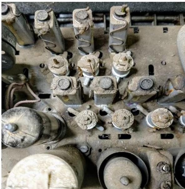
**Figura 1.** Receptores que estiveram há décadas fora de operação, acumulando poeira, como o da fotografia, nunca devem ser ligados afoitamente “para ver se funcionam”. Uma boa limpeza e uma inspeção prévia, minuciosa, da montagem e dos componentes são indispensáveis para o diagnóstico de eventuais problemas no circuito, antes do teste de funcionamento.
