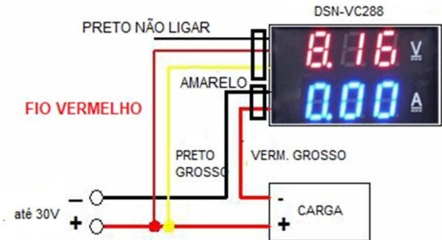
Fig. 6 – Ligação do DSN-VC288 para medição de tensões entre 4,5V e 30V.
