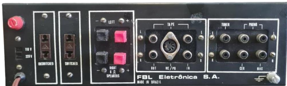
Os conectores são RCA e DIN para entradas de sinal, com pares específicos para fonocaptor magnético e cerâmico, o que era muito bom na época. Conectores de alto-falantes, do tipo de pressão, de boa qualidade, duas saídas de energia CA e um borne para aterramento complementam o conjunto.
