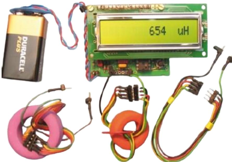
**Figura 5: Exemplo da aplicação do acessório numa medida usando um LC meter de projeto da revista Elektor.**
