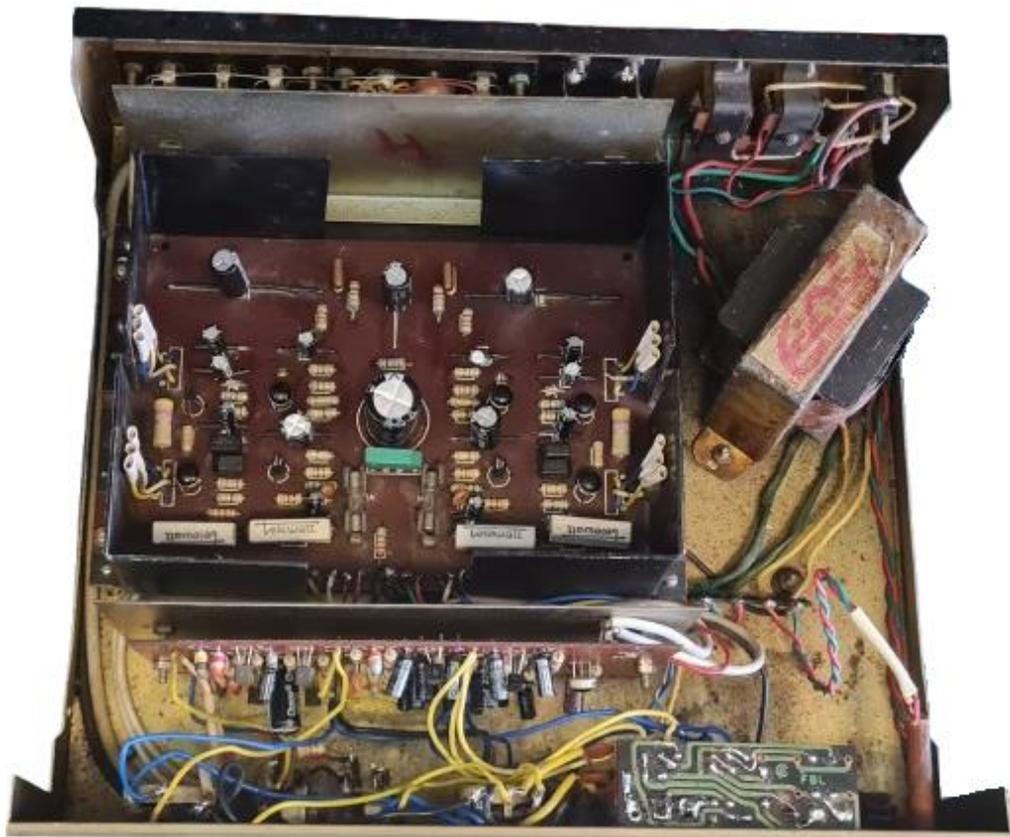
**Interior do AS-1040A com os capacitores trocados e reparações efetuadas**
