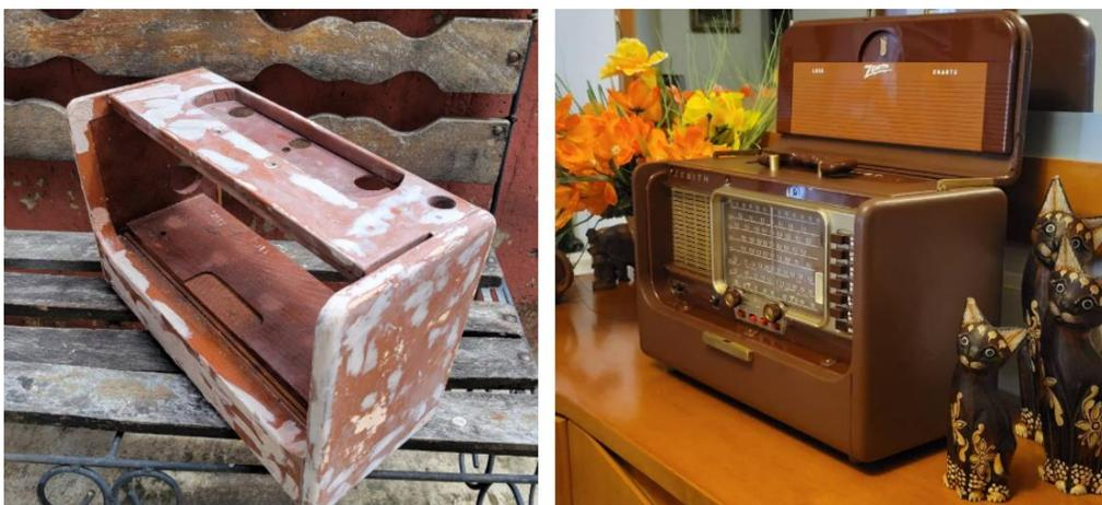
**Figura 10.** O antes e o depois: para a recomposição do gabinete deste bellissimo Zenith Transoceanic A600, foi produzida uma tinta vinílica especial, que imita com perfeição o acabamento original. Além da restauração de toda a parte eletrônica do rádio, foi construída uma bateria “A” e “B”, de 1,5 e 90 V, para a alimentação do receptor. Era um aparelho para ser levado a qualquer parte do mundo, pesando 10 kg, mas, com as baterias novas, o “portátil” pesa, agora, 23 kg!
