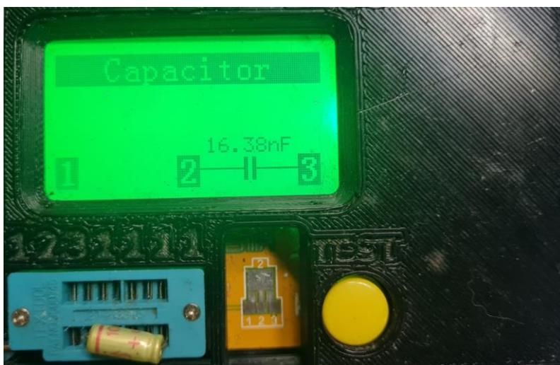
**Capacitor eletrolítico de acoplamento, de 10 $\mu$ F, com defeito**
