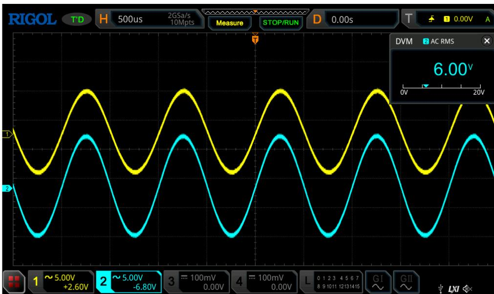
Melhoria significativa na potência disponível para a carga. Na verdade, um canal entra em ceifamento um pouco antes que o outro, e conseguimos, nessa condição, em torno de 6,4 watts em  $8\Omega$ . O consumo medido foi de 33W em  $8\Omega$  e de 46W em  $4\Omega$ .
