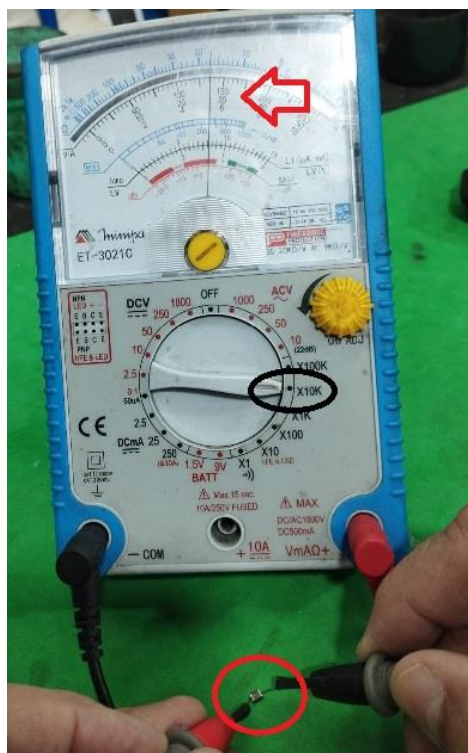
Fig.5 – Capacitor em curto na placa buffer
