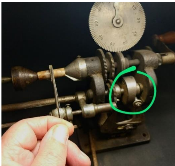
Figura 9: Reenrolamento tipo “honeycomb”, em fio Litz, para reparação de indutor danificado. O mecanismo de came, circulado em verde, possibilita o zigue-zague do fio, característico dos enrolamentos com fios Litz. O condutor Litz é multifilar, o que reduz as perdas. O revestimento isolante em seda ou algodão do fio Litz ajuda a manter o enrolamento “armado”, até que seja protegido com cera ou parafina.
