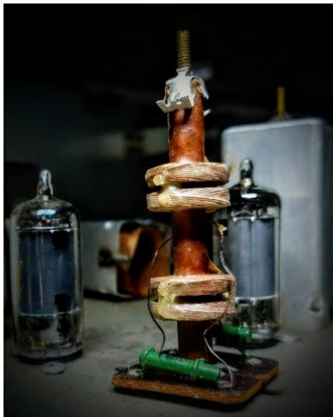
Figura 2: Bobina de FI da Comar: com ajuste por permeabilidade, através de núcleos de material ferrimagnético, apresentavam rendimento elevado ( Q acima de 100), excelente seletividade e boa qualidade sonora, com ótima curva de resposta, graças a projeto e construção esmerados, bem como a um acoplamento crítico cuidadosamente acertado. Acoplamento crítico é o ajuste entre o primário e secundário, influenciando no formato da curva de resposta.
