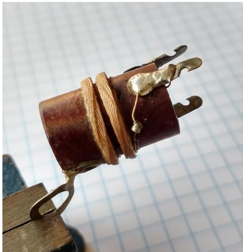
Figura 10: Como pode ser feito o reparo em bobina de fio Litz, cuja ponta estava rompida. Emenda feita com um pedaço de fio rígido, soldado sem remover espiras do enrolamento original.
