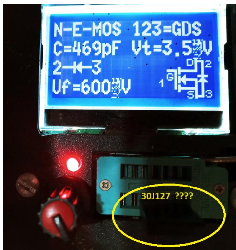
Fig. 4 – Medindo entre terminais do IGBT suspeito
