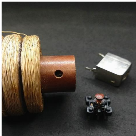
Figura 6: À esquerda, uma bobina osciladora antiga, de alto fator de qualidade “Q”, com enrolamento tipo honeycomb, de fio Litz e núcleo de ar. Bobinas miniaturas para circuitos modernos (à direita, na foto), nas mesmas frequências, enroladas em fios esmaltados, mesmo empregando núcleos de material tipo ferrite, costumemente apresentam “Q” inferior.
