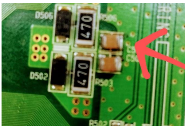
Fig. 4 – Capacitor em curto na placa buffer.
