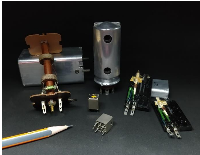
Figura 1: Transformadores de FI de rádios valvulados: existiram em vários formatos, tamanhos e desempenhos. Os dois transformadores miniatura, no centro da foto, são de FIs de aparelhos portáteis transistorizados e foram incluídos na fotografia para comparação de tamanhos.
