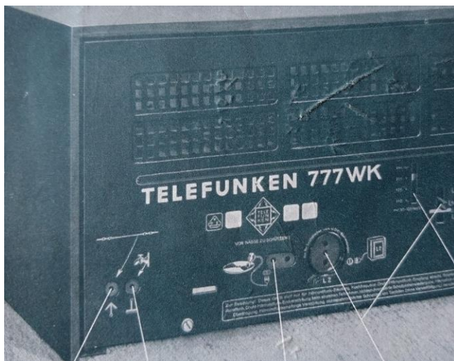
Figura 7. As muitas conexões externas possíveis num receptor Telefunken 777WK, “Tosca”, de 1934. É um aparelho com transformador. Vê-se o terminal para o aterramento do receptor (imagem de uma torneira), junta à entrada de antena. Se o rádio não tiver terminal apropriado nunca o ligue à terra. NUNCA IMPROVISE usando o chassi para aterramento: há risco de curto-circuito e de choques fatais.
