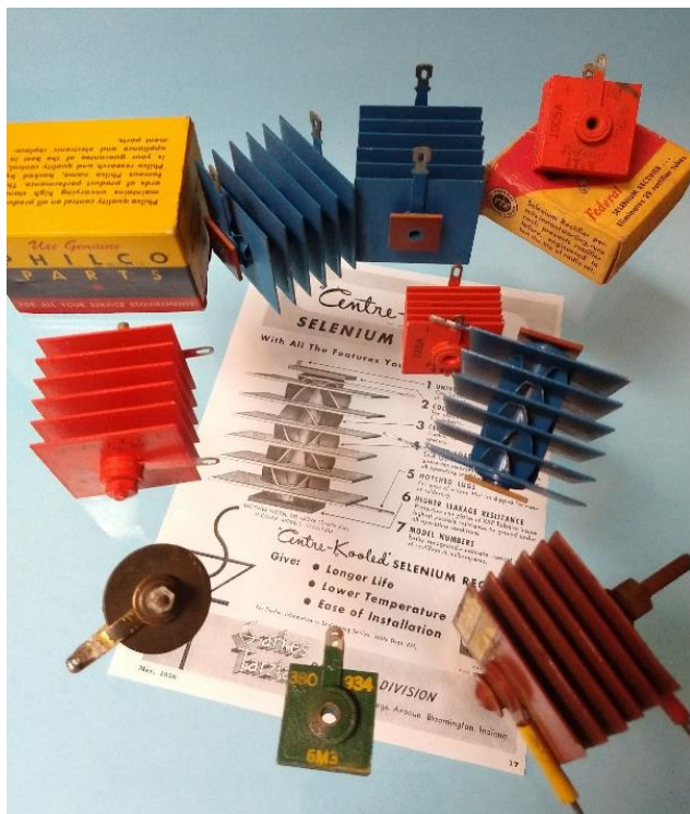
Figura 1. Retificadores de selênio Philco, Federal, Sarkes Tarzian, Zenith e Prodelec. Os de cor azul são Sarkes Tarzian tipo “Centre-Kooled” (“centro resfriado”), com aletas sinuosas no eixo, para ventilação. Eram anunciados como de maior durabilidade e menor temperatura de operação. Nos retificadores de selênio, quando queimavam, o defeito podia ser diagnosticado à distância: o fedor de ovo podre era insuportável, antes mesmo de se chegar no aparelho.
