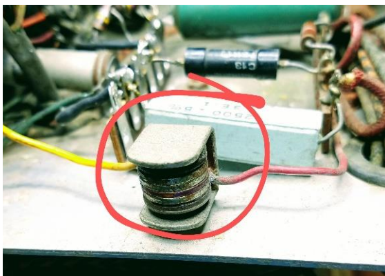
Figura 2. Pequeno retificador de cobre, de meia onda, comum nos instrumentos eletrônicos dos anos 50, empregado no miliamperímetro do provador de válvulas Heathkit TC-3.
