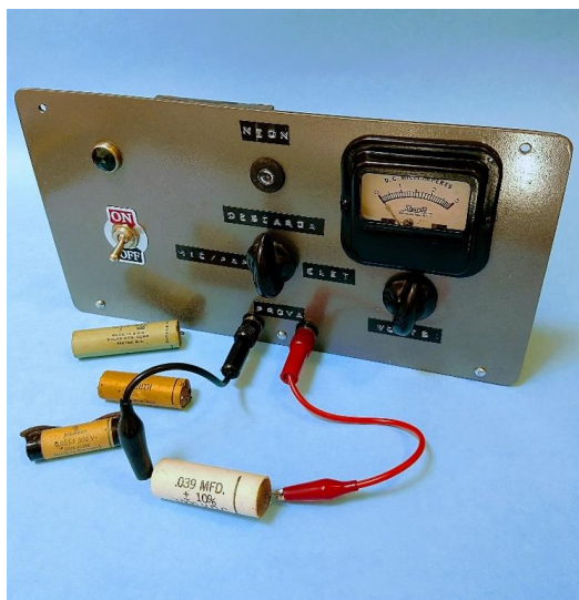
Figura 5. Remontagem do circuito do testador de fuga em capacitores, publicado no Brasil em ANTENNA de 1950. Com exceção do transformador, o novo protótipo do equipamento foi construído com componentes aproveitados da sucata, inclusive o miliamperímetro Shurite, que foi restaurado. O miliamperímetro serve principalmente para a medição de correntes de fuga em capacitores eletrolíticos. Os letreiros do painel, feitos com etiquetadora tipo DYMO, bastante usada na época pelos experimentadores, seguem o visual das montagens caseiras dos anos 50.
