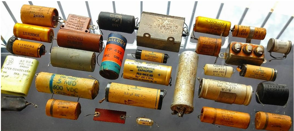
Figura 1. Capacitores polarizados e não polarizados, de papel, mica, poliestireno ou eletrolíticos, fabricados antigamente na Inglaterra, USA, Alemanha, Suécia e Brasil.
