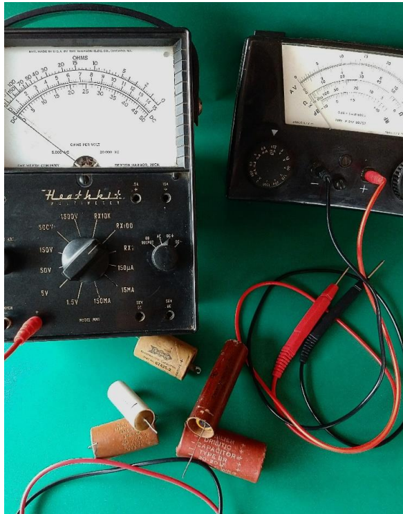
Figura 4: Quem não tem cão, caça com gato. Quando não se tinha um megômetro ou medidor de isolamento para altas tensões, usavam-se ohmímetros capazes de medir valores elevados de resistências. Na foto, medições de capacitores antigos com o Heathkit MM1 (do início da década de 1960, montado a partir de kit), de 20.000 \Omega/V , que funciona com 4+1 pilhas, capaz de medições de até 20 M \Omega e com o multímetro de bancada Philips P 817, de 40.000 \Omega/V , com bateria de 22,5 V, adicional a uma pilha de 1,5V, para medições de resistências de valores elevados. Não descarte os capacitores antigos defeituosos: os invólucros podem ser aproveitados como “embalagem” nas substituições, mantendo o visual da época. O novo capacitor é instalado no interior do encapsulamento e o espaço vazio pode ser preenchido com cera ou adesivo.
