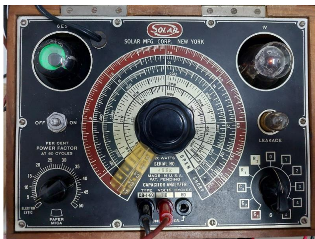
Figura 5. O “Solar Capacitor Analyzer CB-1-60”, de 1945, é um analisador de capacitores e ponte de resistência, com escalas calibradas, em cinco alcances e boa precisão. Nos capacitores mede correntes de fuga, capacitâncias, capacitor aberto ou intermitente, curtos, afere a tolerância e indica o fator de potência do capacitor em teste. É uma bela peça da técnica eletrônica de antigamente, capaz de oferecer excelentes serviços, ainda hoje, na oficina do reparador de equipamentos antigos – (Fotografia: Gilton Filho).
