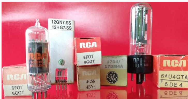
Figura 4. Válvulas com identificação dupla. Podem ser equivalentes? Sim, mas nem sempre são idênticas. A segunda identificação caracteriza uma válvula que foi substituída — ou que deixou de ser fabricada na época.
