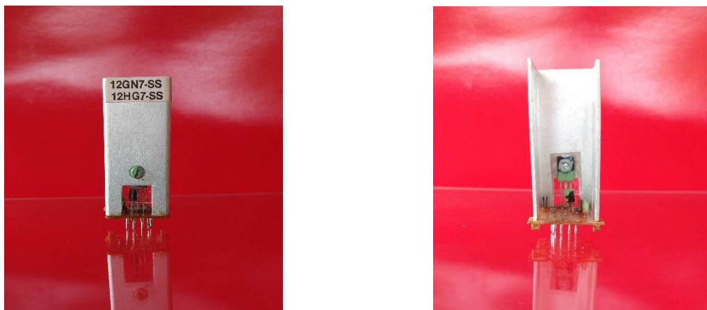
Figura 4. Montado em circuito impresso com nove pinos, transistores e dissipador, o acessório 12GN7-SS/12HG7-SS, serviu para reposição das válvulas pêntodo 12GN7 e 12HG7.
