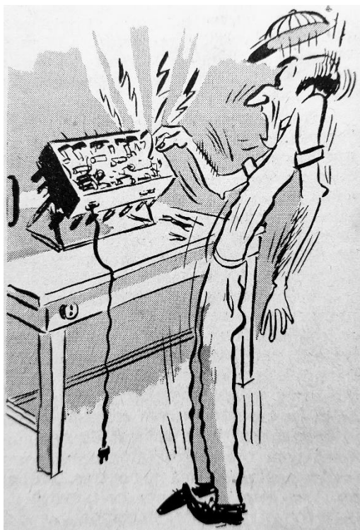
Figura 11. Cuidado! Você sabia que há certos tipos de equipamentos que podem causar choques, mesmo com o plugue do cabo de alimentação não inserido na tomada? Confira no texto quais são esses aparelhos e quais são as medidas de proteção que devem ser adotadas pelo reparador. — (Ilustração: Revista Antenna).
