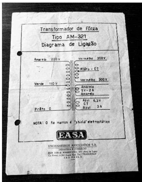
Figura 8. Ligações e código de cores do transformador de alimentação modelo AM-321, da EASA, para circuitos valvulados.
