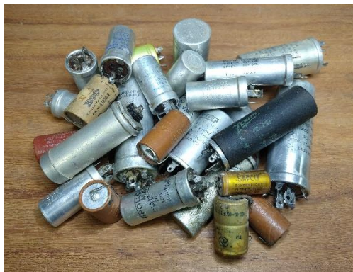
Figura 1. Componentes como capacitores eletrolíticos com defeito são os grandes vilões provocadores de zumbidos. Mas nem sempre.
