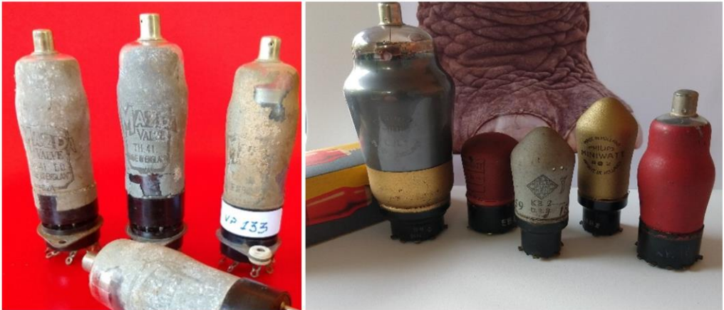
Figura 4. Válvulas antigas com a pintura metalizada que servia como blindagem: à esquerda, válvulas de tipos octais Mazda; à direita, tipo “pata-de-elefante” (base B8A).
