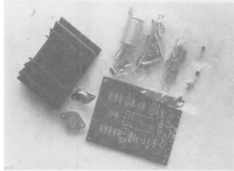
FOTO VII — Componentes de um dos módulos amplificadores de potência. Os semicondutores, resistores, capacitores, bem como as ferragens (parafusos etc.) são acondicionados em divisões individuais no saco plástico.
