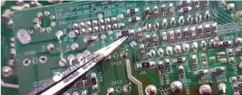
FIG 3 – Resistor de 10K que foi substituído por outro de 330 K
