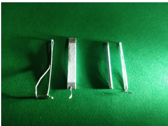
Figura 7. Calefatores de válvulas miniaturas. Os tubos do catodo (centro) são feitos de níquel revestido de óxidos. Os filamentos (nos extremos), ficam montados no interior dos tubos de catodos, envolvidos por uma camada de isolante de alumina.
