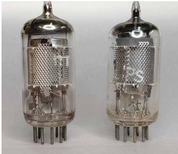
Figura 5. Certas válvulas, como as tipo EF86, foram especialmente desenvolvidas para baixo nível de zumbido. À esquerda uma EF86 ITT-Lorenz, à direita uma EF86 Philips Miniwatt. Pode-se observar que os filamentos, mesmo sendo de válvulas iguais, apresentam montagem diferente: detalhes no texto.
