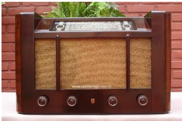
Figura 5. O modelo Philips 697 VN foi um dos que chegou ao Brasil. Receptor de seis faixas, usando 6SG7, 6SA7, 6SS7, 6T7G e 6V6. De excelente desempenho, o equipamento era apresentado como “High Quality Export Radio”. Possui circuito pré-seletor. Funciona com acumulador de 6 V e vibrador. Aparelho do acervo do dedicado colecionador e restaurador João Azzolin, PY3CNQ, que possui vários Philips de procedência americana em sua coleção, todos em estado impecável. — Foto: www.radioantigo.com.br .
