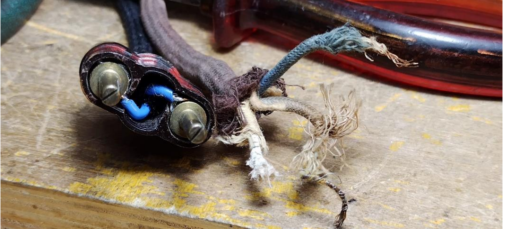
Figura 14. Para quem não o conhece, eis o verdadeiro “rabo-quente”. Não confunda: rabo-quente é o cordão de alimentação com elemento resistivo interno, não é o rádio. — (Fotos de Roland de Smet).
