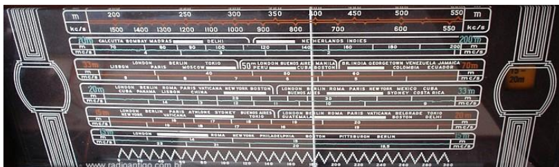
Figura 6. O belo mostrador do rádio Philips 697 VN, produzido nos Estados Unidos. Pode-se perceber que a maioria das estações marcadas no mostrador é de países distantes, indicando tratar-se de um receptor destinado para exportação. É um dos modelos que chegou no Brasil na década de 1940. — Foto: João Azzolin, https://qsl.net/py3cnq/philips.htm .
