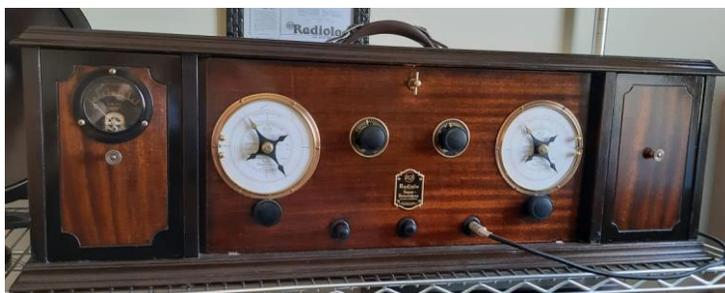
O aparelho tinha um gabinete em madeira composta (não maciça como a maioria dos rádios dos anos 1920), com acabamento em mogno em duas tonalidades, antena de quadro interna, 2 compartimentos para baterias A e B, um pequeno compartimento interno para a bateria C e conexão para antena externa.
