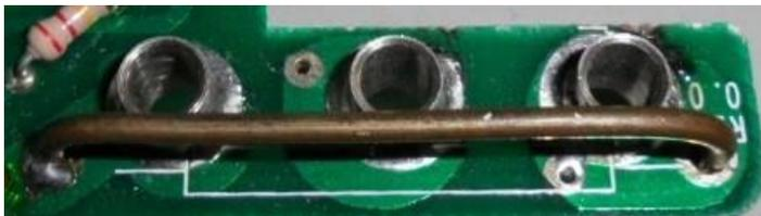
Fig. 4 – Shunt de corrente para medição de correntes até 10A.
