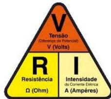
**Moral da história:** - para ler correntes nos multímetros digitais precisamos “transformá-las” em tensão, ou melhor, precisamos de um conversor corrente-tensão, e nada mais simples para realizar esta tarefa que uma resistência, não é mesmo?
