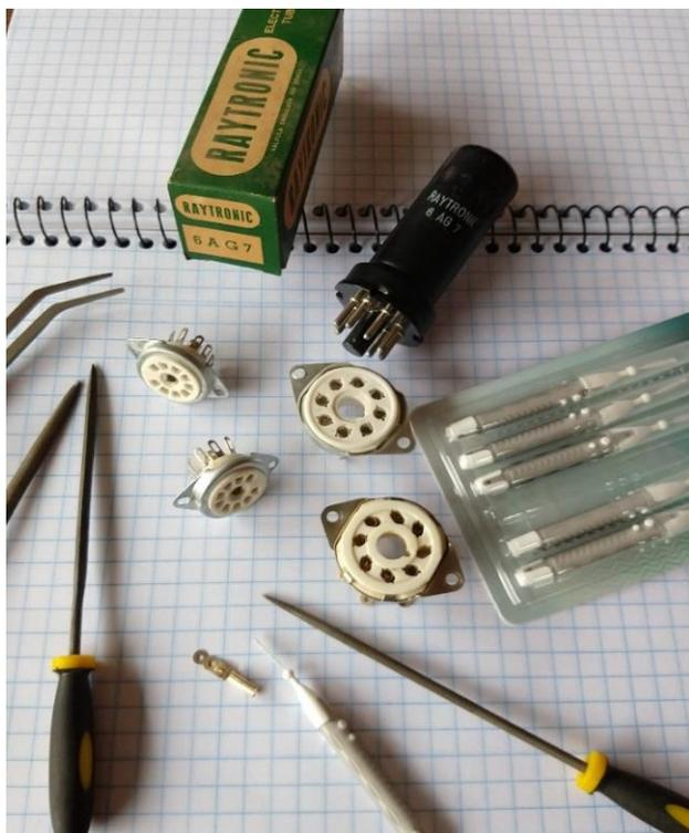
**Figura 9.** Algumas ferramentas usadas na limpeza de soquetes: limas finas, escovas interdentaes. Demais materiais e procedimentos acham-se descritos no texto. A válvula 6AG7 que aparece na foto, mesmo nova, apresentava intermitências no funcionamento: deixava de oscilar. O problema não era na válvula, mas em mau contato que ocorria em terminal oxidado do soquete.
