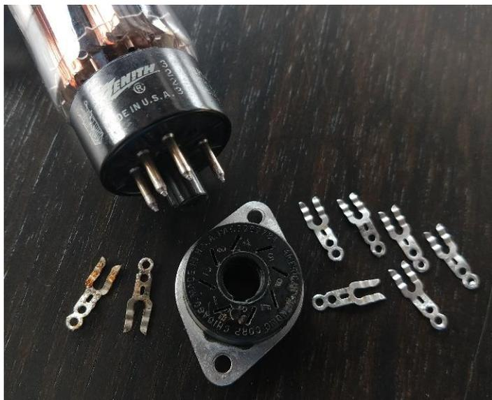
***Figura 8. Não apenas os pinos das válvulas precisam estar livres de oxidações. Os contatos nos soquetes também precisam estar impecáveis para que ocorra o perfeito funcionamento dos circuitos.***
