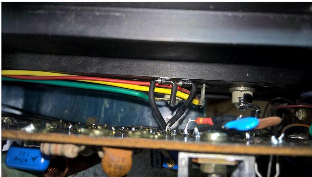
Foi colocado um pouco de pasta térmica entre eles e o dissipador. Eu acho a fixação da placa um pouco frouxa, assim, recomendo a quem for fazer algo semelhante travar firmemente os diodos no dissipador, com alguma garra metálica ou algo similar. Farei isso neste amplificador, futuramente.
