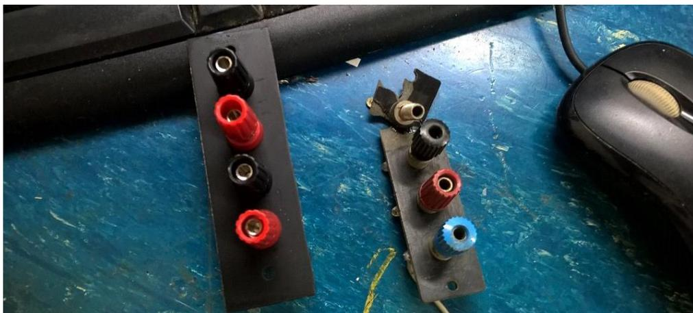
O conjunto de bornes de saída foi substituído em decorrência da placa de suporte estar quebrada. Adaptei uma com um placa de PCI de fibra de vidro, da qual todo o cobre foi corroído, de uma outra montagem.
