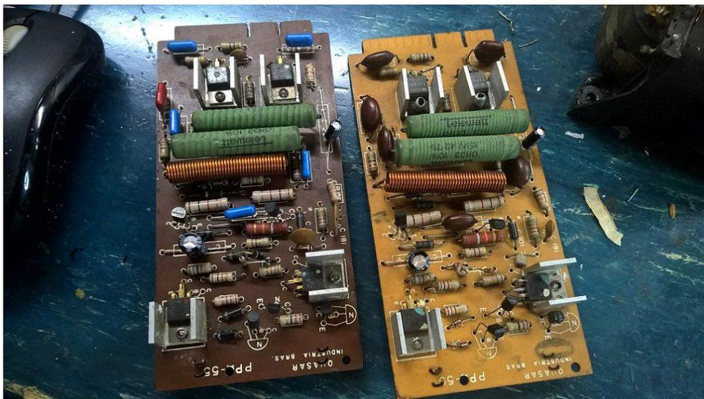
A da direita aparenta mais antiga e ter passado por manutenção nos drivers, com os capacitores originais Siemens "caramelo" de poliéster metalizado, todos ainda em boas condições.
