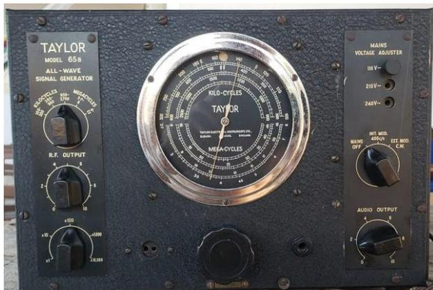
*Figura 13. Gerador de sinais Taylor modelo 65B, outro clássico dos instrumentos de bancada, colocado em plenas condições de funcionamento.*
