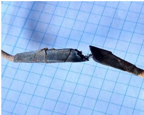
**Figura 3. “Reparo” em “rabo-quente” fez o cabo entrar em combustão, queimando a fita isolante de pano. Fios de liga de níquel não permitem remendos.**
