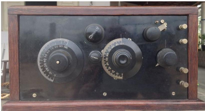
*Figura 14. Um autêntico regenerativo “homebrew”, de 1927, restaurado. A data provável de fabricação do receptor caseiro foi descoberta através de um recorte de jornal americano, todo amarelado, que o antigo proprietário havia esquecido, dobrado, no interior do rádio. Tensões de operação: 6, 22,5 e 90V.C.C.*
