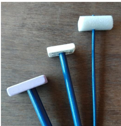
Figura 4. Marteletes improvisados com borrachas escolares ou espumas de alta densidade podem ser úteis na pesquisa de maus contatos em válvulas e soquetes.
