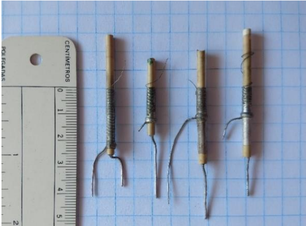
Figura 5. Serão indutores? É um tipo de terminal de ligações? Serão capacitores tubulares fixos? Não, são capacitores ajustáveis de fio.
