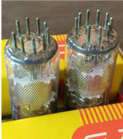
Figura 1. Válvulas novas de estoque antigo, com pinos de ligas tipo FerNiCo / Kovar, atacados por oxidação.
