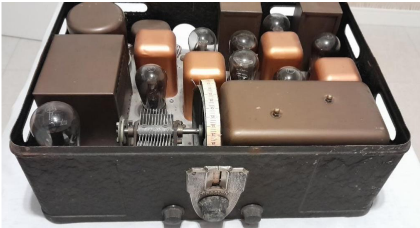
Figura 11. Vista frontal e do interior do Crosley modelo JewelBox (USA, 1928/1929), com sete válvulas e alimentação por C.A. O gabinete é todo de metal.
