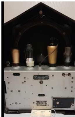
Figura 11. Vista frontal e do interior do Crosley modelo JewelBox (USA, 1928/1929), com sete válvulas e alimentação por C.A. O gabinete é todo de metal.
