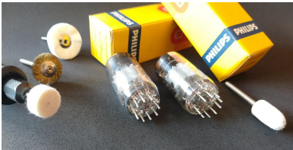
Figura 2. As mesmas válvulas, com remoção dos óxidos metálicos nos pinos feita por decapagem química e escovação/brunimento. Detalhes dos procedimentos no texto.
