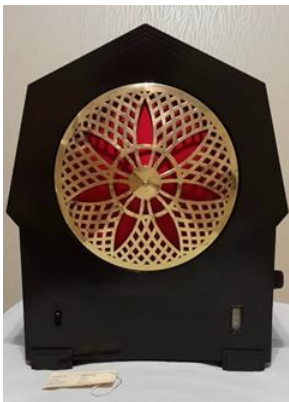
Figura 11. Vista frontal e do interior do Crosley modelo JewelBox (USA, 1928/1929), com sete válvulas e alimentação por C.A. O gabinete é todo de metal.
