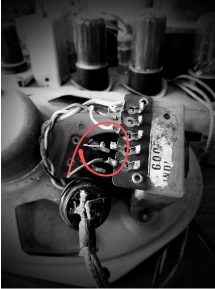
Figura 6: Tentar fazer aparelho valvulado funcionar com o alto-falante desconectado pode danificar a válvula de saída, o transformador de áudio e/ou outros componentes.
