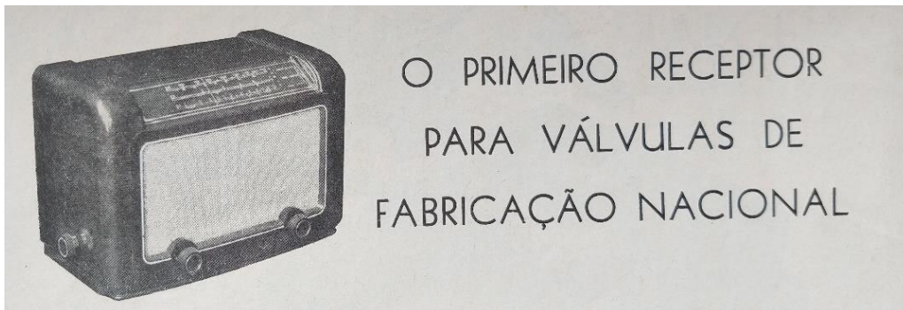
Figura 4. O primeiro receptor com válvulas fabricadas no Brasil foi desenvolvido pela Ibrape, em 1953. O circuito usava bobinas da marca Comar e foi um grande sucesso, sendo reproduzido por centenas de montadores – e por muitas indústrias nacionais.
