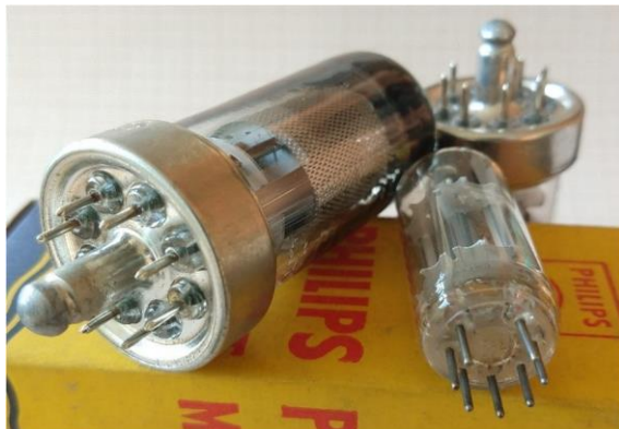
Figura 9. Com a criação de ligas especiais com ferro, níquel e cobalto, de baixa oxidação e com o mesmo fator de dilatação do vidro, foi possível a produção de válvulas menores e inteiramente de vidro. Com pinos passantes ficavam facilitadas as ligações diretamente aos elementos internos.
