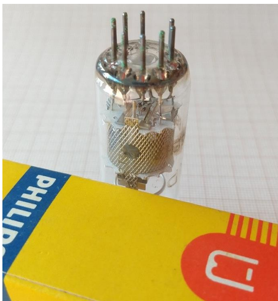
Figura 10. Válvula sem uso, NOS, Philips tipo EF183/6EH7: os pontos iniciais verdes de oxidação nos pinos pode indicar a exposição de partículas de óxido de cobalto da liga do metal. Os maus contatos entre os pinos e os soquetes são causas bem frequentes, hoje em dia, de problemas como ruído, intermitências, instabilidades e outros defeitos no funcionamento dos circuitos com válvulas de fabricação antiga. Numa das próximas edições de Dicas e Diagramas voltaremos ao assunto.
