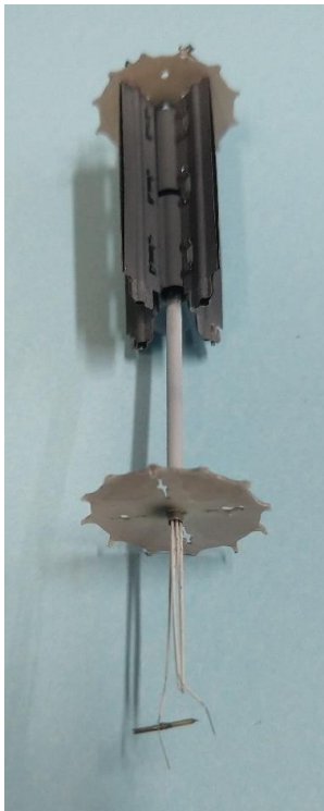
Figura 8. O físico Arthur Wehnelt descobriu que a emissão de elétrons poderia ser extraordinariamente aumentada caso elementos como o filamento/catodo fossem revestidos com óxidos como o de tório.
