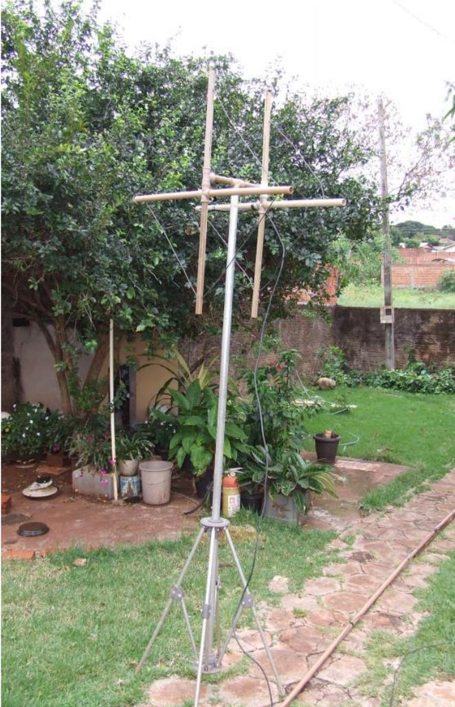
Já publicada em Antena anteriormente, na foto ao lado, vemos uma antena Quadra Cúbica para 144 MHz, de alto ganho. Por ser construída em PVC, ela torna-se bastante resistente às intempéries e é fácil de ser carregada. Neste caso, não usamos cola para fixar os dois quadros, permitindo assim que ela possa ser desmontada e levada no porta-malas do carro. A parte do suporte, onde estão o “T” e a cruzeta estão, sim, colados com cola própria para PVC “soldável”.
