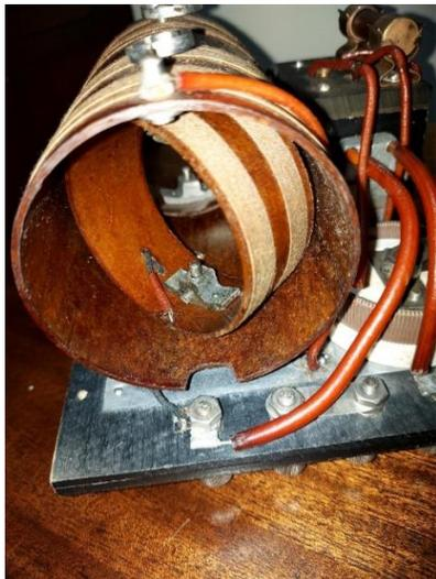
Foto 4: em detalhe, os indutores do variômetro do Aeriola.
