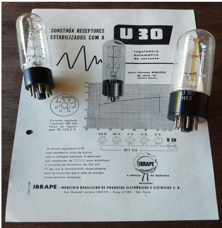
**Figura 4.** Reguladoras da Philips/Ibrape (D) e da Osram (E). A configuração, ferro-hidrogênio proporcionava uma “estabilização automática” da corrente frente às flutuações da tensão nos receptores.
