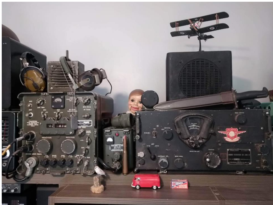
Figura 16. Alguns veteranos militares da coleção de Pedro Freitas, como o receptor BC-348 (à direita), que equipava os bombardeiros B-17, B-24, B-25, B-26, aeronaves como o C-47 etc. O receptor BC-348 foi usado também na superfortaleza voadora B-29. O BC-348 da foto possui patch do esquadrão da USAF de San Antonio, Texas. O receptor é para LF/MF/HF e, nas aeronaves, operava alimentado por dinamotor. À esquerda está um Collins R-392/URR, de 25 válvulas, alimentado por 28 V (inclusive nas placas). O R-392 opera de 0,5 a 32 MHz, em 32 bandas. Possui dois estágios de RF e seis estágios de FI.
