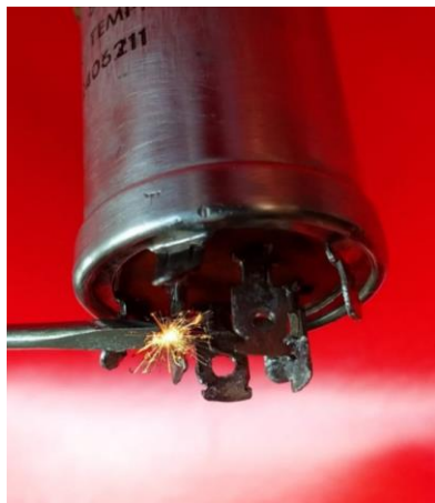
Figura 1. Não se aconselha descarregar capacitores de capacitâncias elevadas através de curtos-circuitos. O recomendável é descarregá-los através de um resistor. — (Imagem: Tito Efrom).
