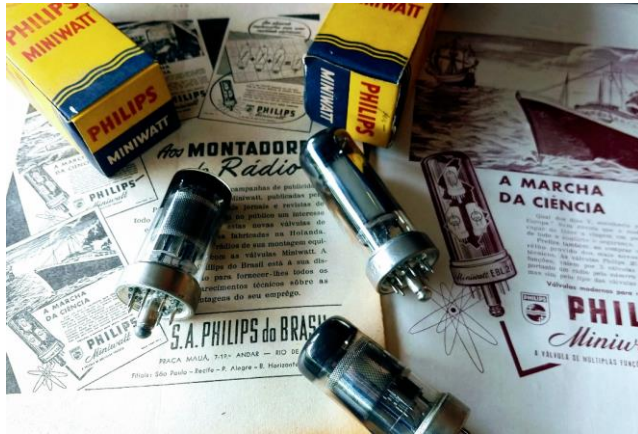
Figura 8. Algumas “válvulas de múltiplas funções” da Philips, na década de 40. À direita, acima, está a EBL21.
