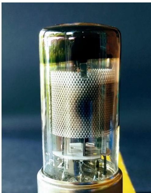
Figura 10. A loctal ECH21, de 1941, um triodo-heptodo da linha de válvulas múltiplas da Philips Miniwatt.
