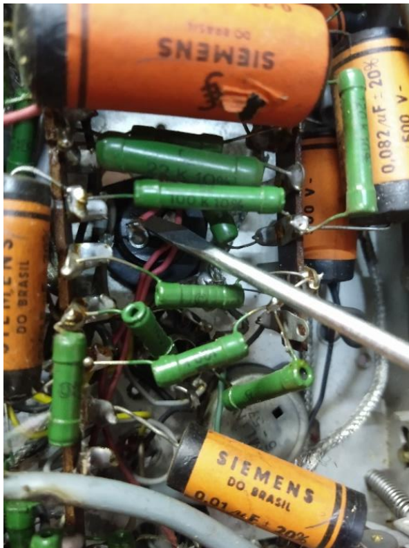
Figura 2. Bulir com chave de fenda através de aparelho valvulado, buscando descarregar capacitores eletrolíticos, poderá causar danos também a outros componentes.
