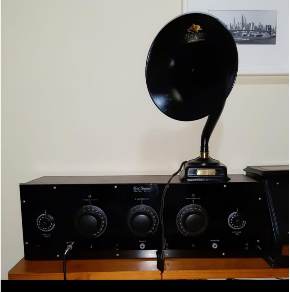
Figura 21. Outro magnífico trabalho: o elegante Freed-Eisemann Neutrodyne Receiver, produzido em Nova Iorque de 1923 a 1924, utilizando cinco válvulas tipo 201-A.
