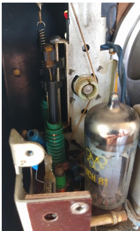
Figura 15. Detalhe do sistema de sintonia “Variometerspule”, de sintonia por variação indutiva (na foto, ao fundo), sem o uso de capacitor variável, adotado no receptor.
