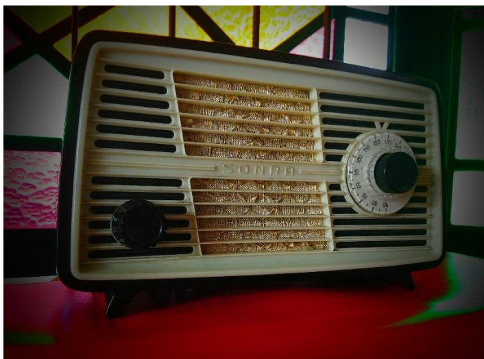
Figura 12. O interessante receptor compacto VEB Stern-Sonra Radio Sonneberg, modelo Kleinstsuper 64/58 GW, “Bobby”, fabricado na Alemanha Oriental: tinha apenas três válvulas, mas apresentava desempenho equivalente ao de aparelhos mais elaborados. — (Receptor: cortesia Daltro D’Arisbo).
