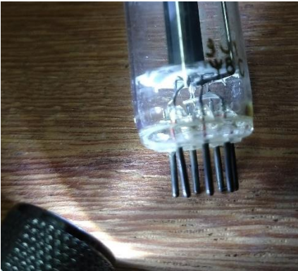
Figura 10. O grupo “3U” inscrito na base desta válvula identifica a duplo diodo-triodo EBC91/6AV6. O símbolo representativo da letra grega Psi ( \psi , em formato de tridente, no início da segunda linha), indica que o produto foi fabricado na S.A. Philips do Brasil/Ibrape, de São Paulo.
