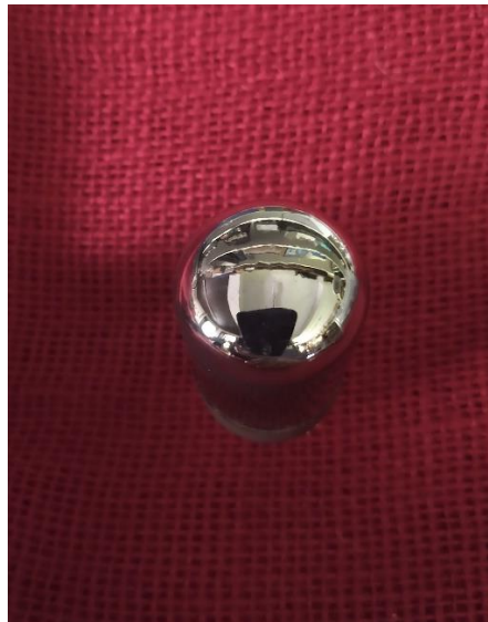
Figura 3. Válvula tipo Loctal, sem identificação visível, sob luz natural.
