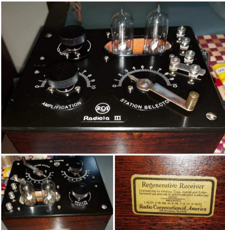
Figura 20. Um outro clássico restaurado, que nas mãos de Marcelo Cipulo Almeida voltou a ficar "mint condition": receptor regenerativo RCA, Radiola III. O receptor funciona com dois tríodos tipo WD11, um como detetor e o outro como amplificador de áudio. Opera com fones de ouvido e baterias tipo A, B e C: a tipo A é de 1,5 V, a tipo B é de 90 V e a tipo C é de 4,5 V. O circuito tipo regenerativo foi inventado por Edwin Armstrong: milhares de receptores Radiola III foram vendidos pela RCA desde que o aparelho foi lançado na década de 1920.
