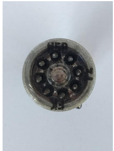
Figura 11. Checando-se cuidadosamente a identificação, borrada, descobriu-se que se tratava de uma válvula retificadora UY41 (pelo grupo de letras “N5”), feita na Holanda. Agradecemos as sugestões trazidas por Ivair Francisco de Souza – o dedicado Radioveio Componentes da internet – para a elaboração deste artigo. O nosso colega Ivair é um grande conhecedor de tipos de válvulas.
