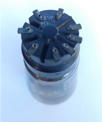
Figura 2. O código auxiliar de identificação (“5W”), gravado na base, indica que a válvula “misteriosa” é, provavelmente, a PEN-A-4, um dos primeiros pêntodos a conseguir acionar diretamente, com bom volume, a bobina móvel de alto-falantes.
