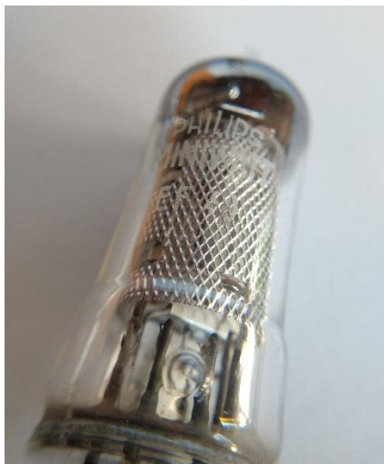
Figura 7. Válvula Philips, Rimlock, com parte da identificação que deixa dúvida quanto ao tipo (EF...).
