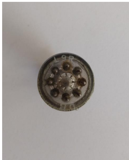
Figura 8. A mesma válvula Philips Rimlock: o grupo “L9” do código da base confirma que se trata do tipo EF40 (v. os links informados no texto).
