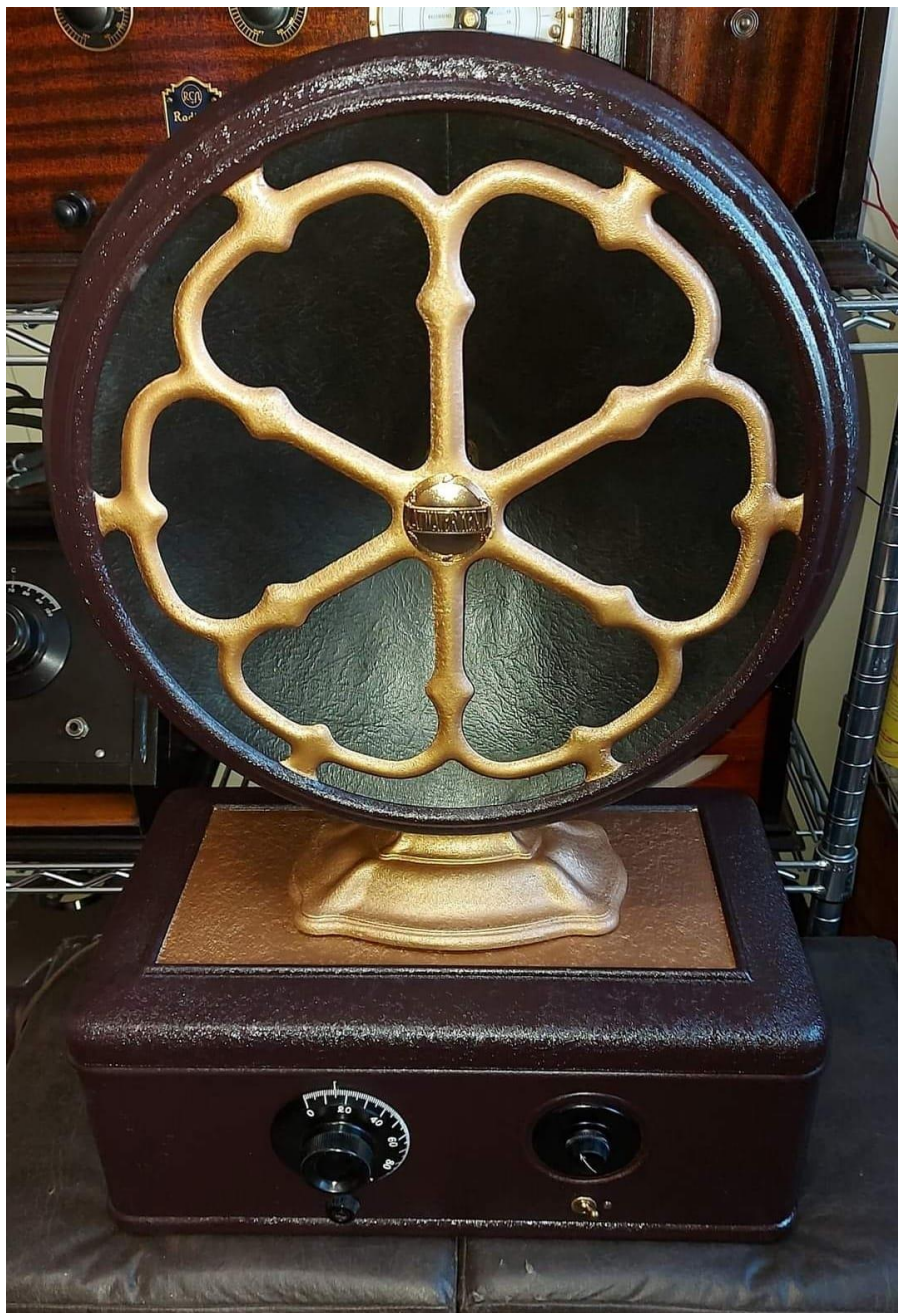
Figura 18. ... e o depois. Trabalho pronto: um Atwater-Kent modelo 40, de 1928/1929, luzindo como novo. Foi um dos primeiros rádios para corrente alternada produzidos pela marca.
