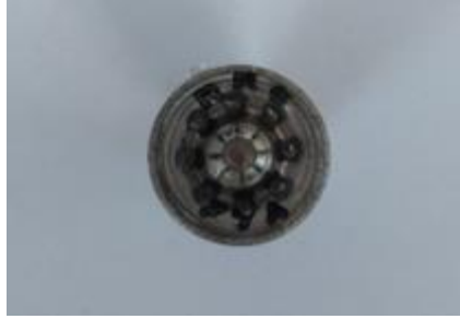
Figura 9. As letras “RR” da identificação gravada na base indicam que se trata de uma válvula tipo EAF42.
