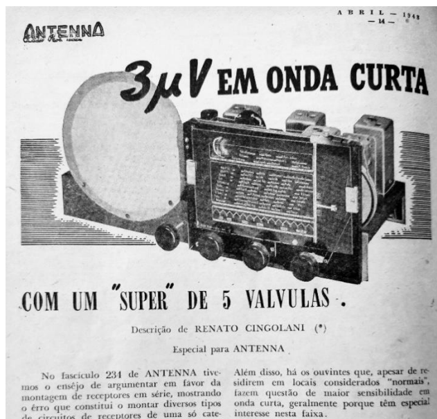
Figura 1. Um dos primeiros projetos, ao alcance dos montadores brasileiros, de receptor de boa sensibilidade publicado por Antenna. A maioria dos aparelhos comerciais da época apresentava sensibilidade de cerca de 10 \mu\text{V} para ondas curtas e 15 \mu\text{V} para onda média.
