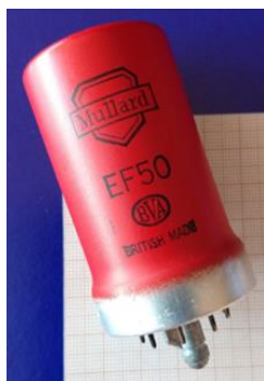
Foto 1. A válvula EF50 adotava fios curtos e disposição especial na montagem dos eletrodos aos pinos da base. Foi o primeiro tipo de válvula, desenvolvido com sucesso, na técnica de fabricação "all-glass". Como reforço recebia ainda um encapsulamento externo em alumínio, para atendimento de especificações militares.
