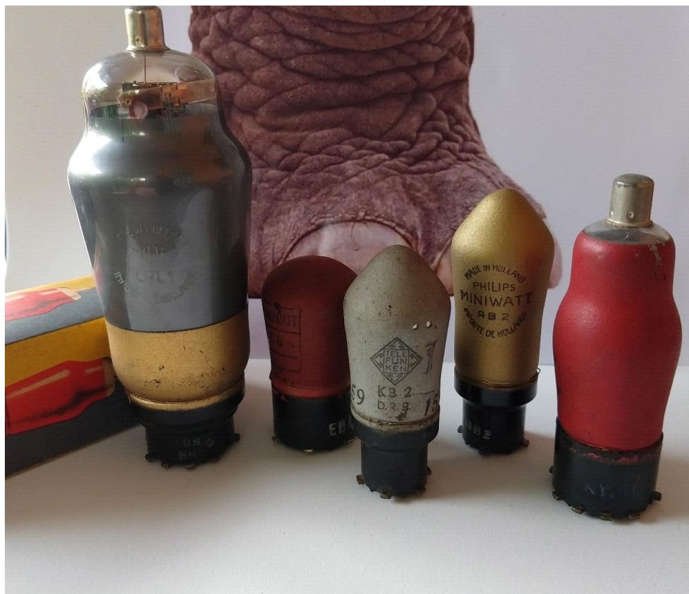
Figura 2. Válvulas Telefunken e Philips tipo "pata-de-elefante". A pintura metálica funciona como blindagem.
