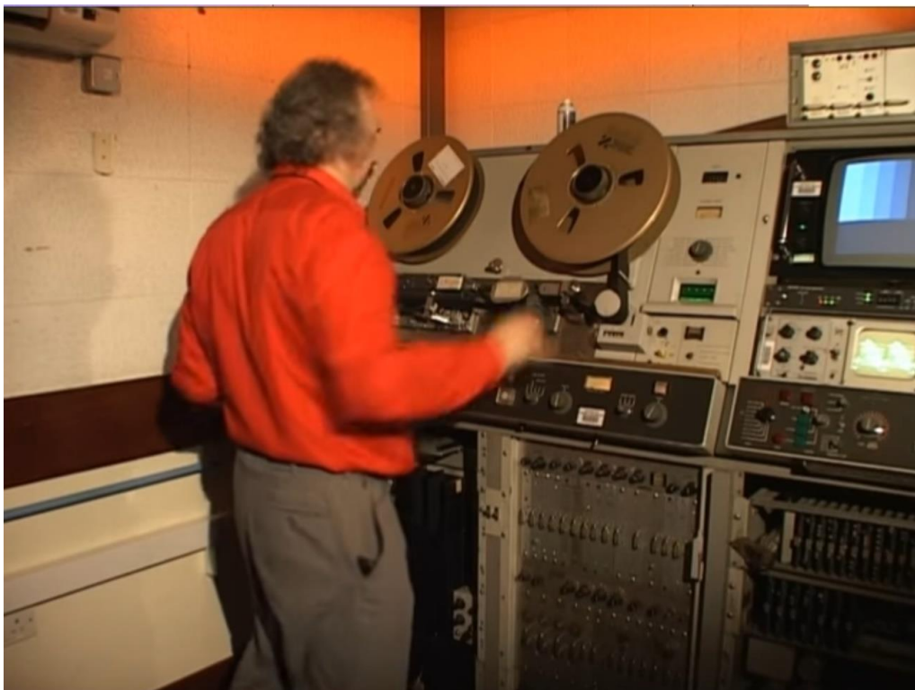
FIGURA 2 – SISTEMA QUADRUPLIX COM FITA DE VÍDEO DE 2 POLEGADAS.
