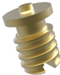
Figura 12 – Diodo Gunn DC1200 de GaAs, fabricado pela Teledyne Lincoln Microwave.
