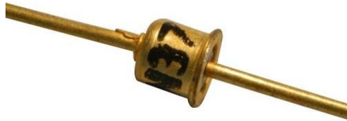
Figura 10 - Diodo túnel 1N3712, fabricado pela Germanium Power Devices Corp.
