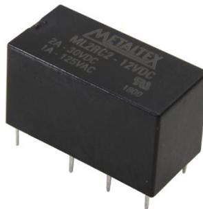
Para K1, K2 e K3, a corrente e a tensão de trabalho são baixas, entretanto, K4 comuta a corrente de coletor durante 2s. Como a fonte de tensão tem limitação de curto em torno de 2A, colocamos os dois contatos em paralelo, inicialmente, perfazendo 4A de capacidade máxima, por precaução.
