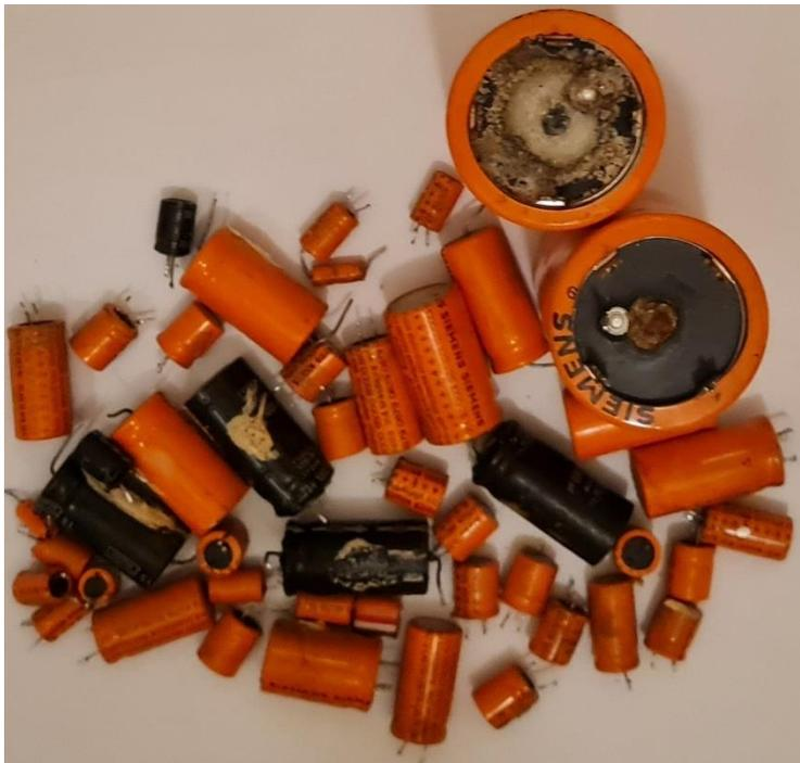
Com os capacitores trocados, ligamos o equipamento e, durante as medições iniciais, percebemos que um dos canais apresentava deformação na parte positiva da senoide de teste, mesmo sem carga, apesar de não apresentar desvios de tensão contínua na saída. Com certeza, com carga, haveria problemas.
