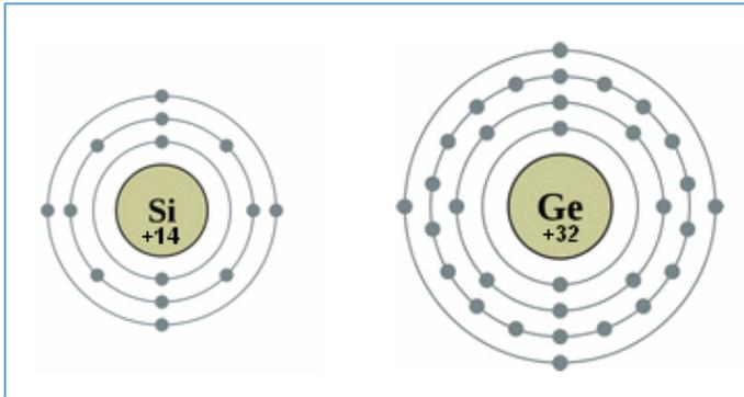
**Figura 2 – Estrutura dos átomos de Silício (Si) e Germânio(Ge).**
