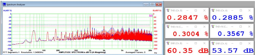
Os valores de distorção são bons, mas superiores aos divulgados, a partir de 10W. como a resposta em frequência medida diretamente na seção amplificadora foi consistente, fizemos medições em 8Ω, até o limite do ceifamento, nesta condição, e os resultados foram consistentes com os publicados. A relação sinal ruído é boa mas inferior à divulgada (85dB).
