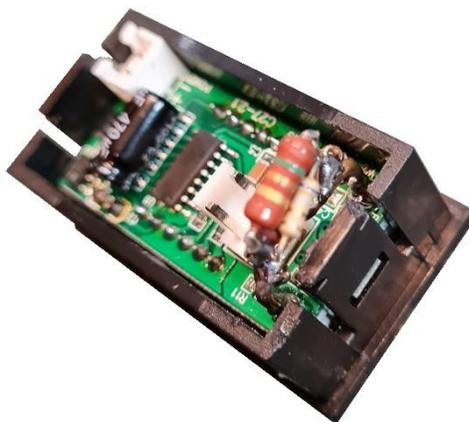
Para cada medidor no mercado, o ajuste do resistor de shunt pode ser diferente, assim, os valores acima são exemplos, para o meu caso, em particular.
