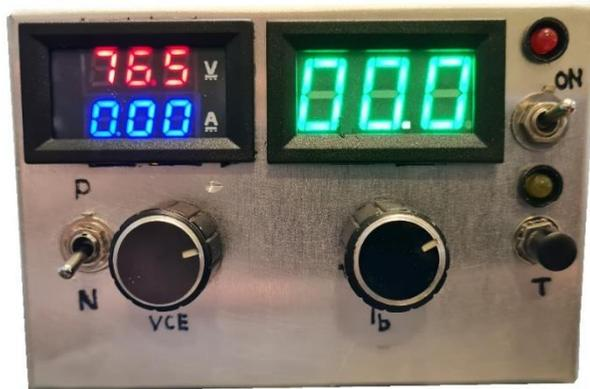
O funcionamento é bastante simples, conforme já descrito: após selecionar a polaridade do transistor a ser medido, coloque-o no soquete e atarraxe firmemente os parafusos de fixação; imediatamente, o medidor de  $I_b$  deverá informar um valor de corrente. Coloque o potenciômetro de  $I_b$  na posição de menor valor e ajuste  $V_{CE}$  para o valor desejado de teste.
