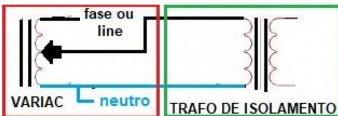
Fig. 1 – Variac e transformador de isolamento
