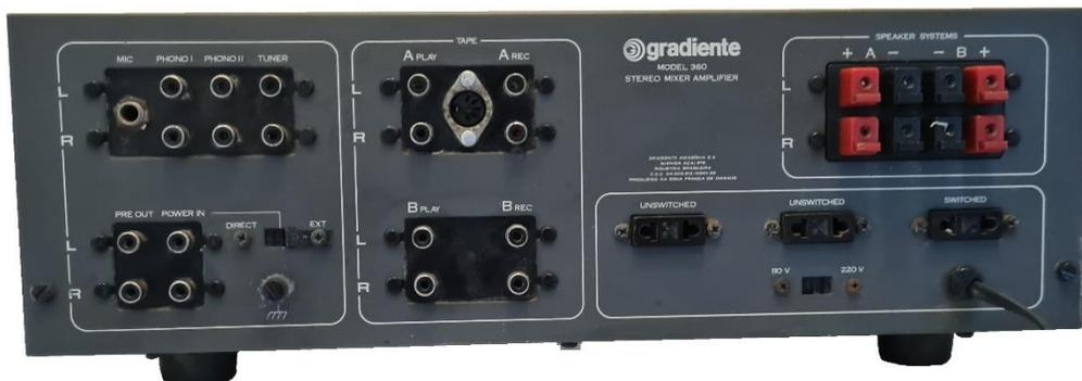
Observa-se que o chassis do aparelho é o mesmo do amplicetor Model 1450, lançado antes, de forma que a Gradiante “sacrificou” uma entrada de alto nível para dar lugar à segunda entrada de fonocaptor (phono II), assim, o equipamento não tem entrada auxiliar, o que não é grande problema, pois dispõe de duas entradas para gravadores e uma para sintonizador.
