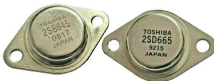
**Par de transistores de saída utilizados no Model 360 (imagem do eBay)**
