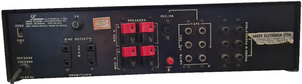
No painel traseiro, duas saídas comutadas de energia, os conectores de sonofletores, do tipo de pressão, bem práticos para testes e as entradas tradicionais, além das conexões de monitoração e de gravação.
