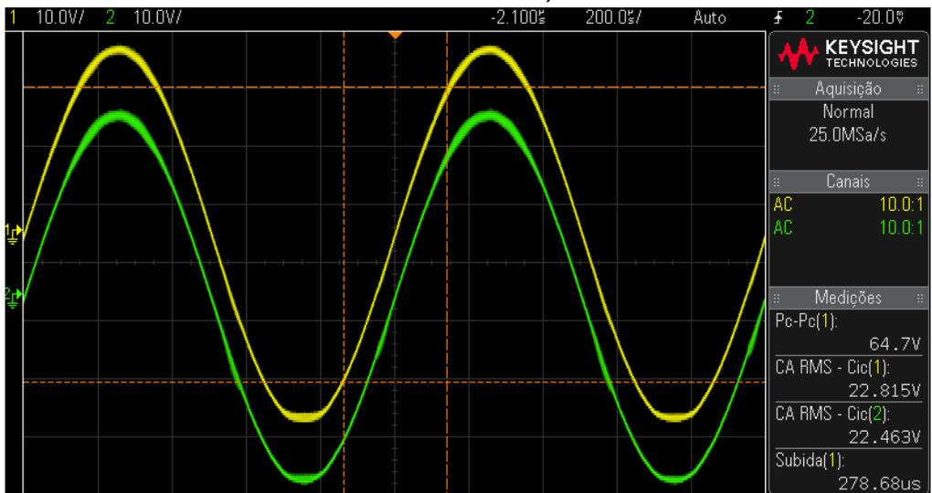
Como a informação é de que a potência máxima seria de 90W, por canal, sem informar com qual impedância, entendemos que esta seria de 4Ω, o que é interessante, pois, neste amplificador, quando utilizamos dois pares de caixas, o seletor de falantes as coloca em série na posição A+B, e não em paralelo, como é comum. Disso resulta que podem ser utilizadas quatro caixas com 4Ω de impedância.
