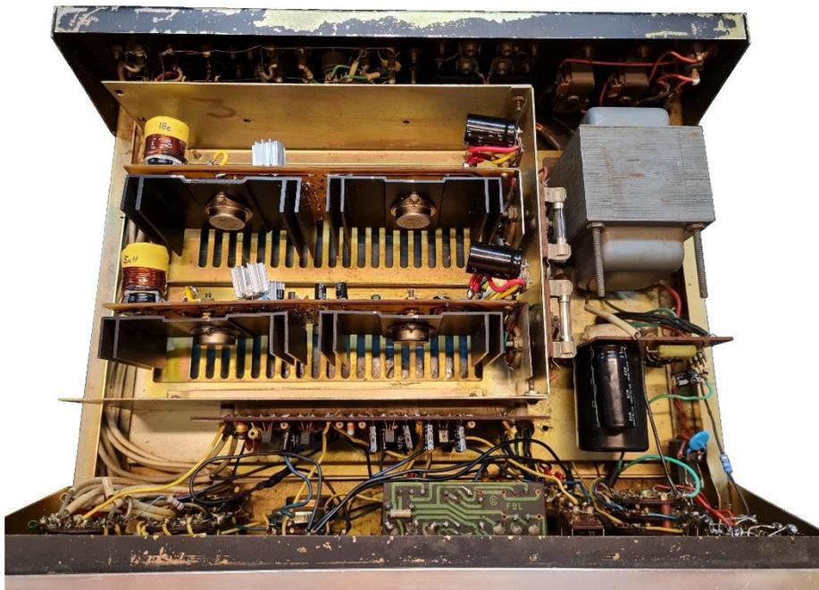
Também colocamos, junto ao conector de cada módulo, um capacitor entre o +B e o 0V, de 330 $\mu$ F/63V, que, ligado após o fusível de proteção, proporcionou uma melhor estabilidade nas linhas de alimentação.
