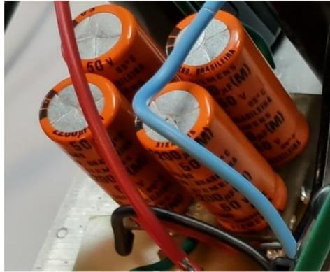
Utilizaremos unidades da década de 1990, de uma fonte para testes de protótipos de amplificadores, usada durante quase dez anos, em regime de estresse e calor. Eles representarão bem unidades antigas e muito usadas em amplificadores da vida real. No capacitímetro, todos os capacitores mostraram capacitância de aproximadamente 1800uF, o que está dentro de sua faixa de tolerância.
