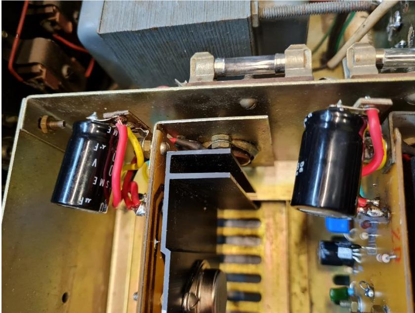
Após encerrada a montagem, energizamos o aparelho e fizemos um reajuste na corrente de repouso dos módulos QUAD. Isso foi necessário pela redução da tensão de alimentação em relação à utilizada nos testes individuais, e nos trouxe boas surpresas nas medições do amplificador completo.
