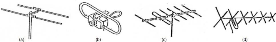
FIGURA 6- ALGUNS TIPOS DE ANTENA: (A) DOIS ELEMENTOS, (B) DIPOLO DOBRADO, (C) YAGI E (D) X-QUAD.
