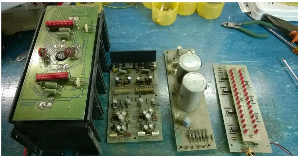
Infelizmente, apesar da robustez, a placa dos transistores de saída literalmente pegou fogo, creio que por conta de alguma "mãozada" de algum técnico de manutenção, o que destruiu as trilhas e também um dos contatos do relé de saída, na placa da fonte.
