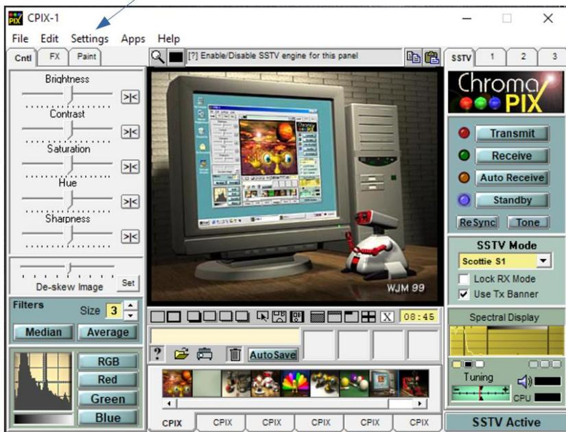
Estas configurações são fundamentais para o funcionamento da nossa interface. Elas fazem com que o micro ative a porta COM e acione o PTT do seu aparelho. No nosso caso, um transceptor Faixa do Cidadão que obviamente não tem VOX incorporado.
