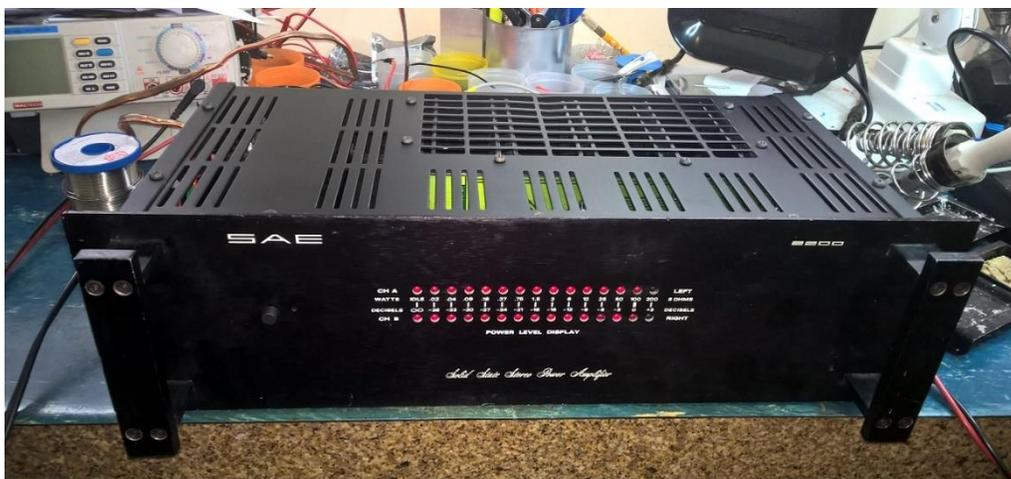
Aliás, para se ter uma ideia do cuidado da SAE com seus projetos e montagens, essa foto mostra o amplificador alimentado por uma onda senoidal de 1kHz com cargas de 8 ohms. O VU aponta precisamente a potência eficaz entregue à carga: 100W. Não fiz nenhum ajuste nesses VU. Estão como vieram de fábrica, há uns 40 anos, ou mais...
