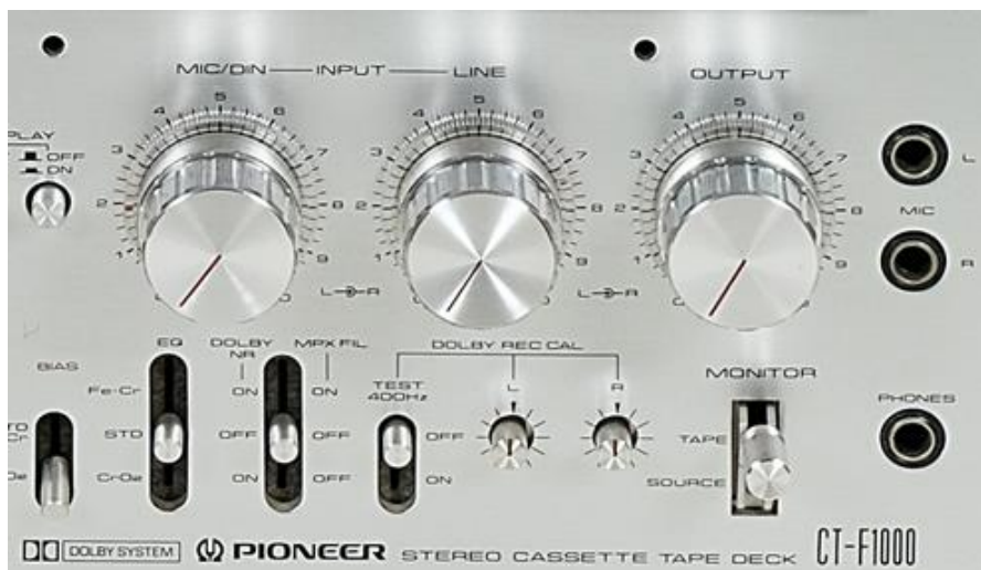
FIGURA 10 – DETALHE DE UM TAPE DECK CASSETE DOMÉSTICO COM REDUTOR DE RUÍDO DOLBY B (1977).
