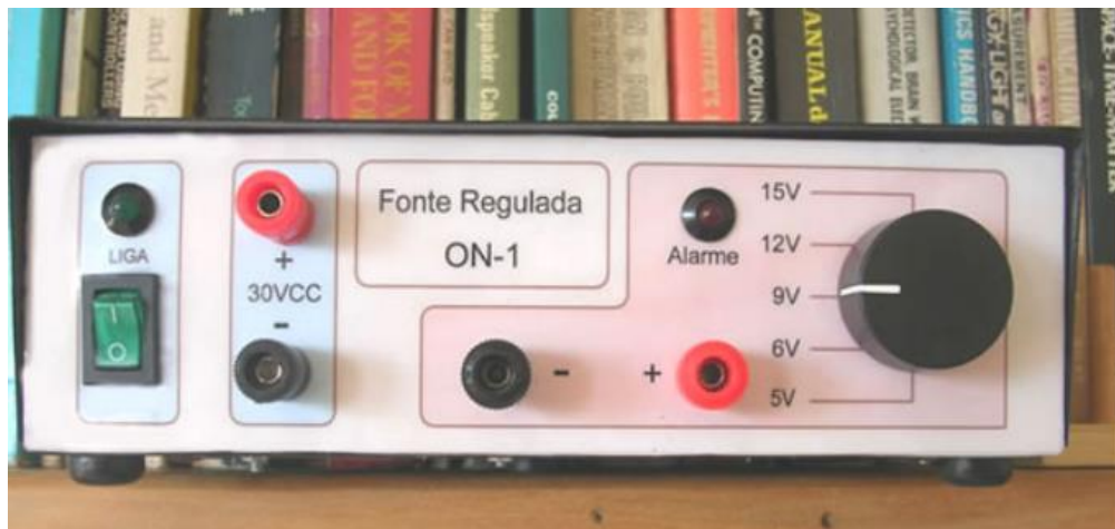
Foto 6: Painel da fonte montada
