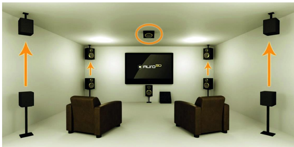
FIGURA 14 - DISTRIBUIÇÃO DE SONOFLETORES PARA O SISTEMA AURO-3D.
