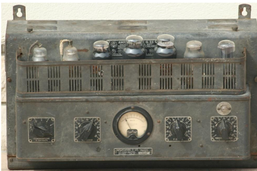
FIGURA 9- AMPLIFICADOR VALVULADO GELOSO G33 FABRICADO EM 1938 NA ITÁLIA SOB LICENÇA DA WESTERN ELECTRIC. FONTE: RADIO MUSEUM.
