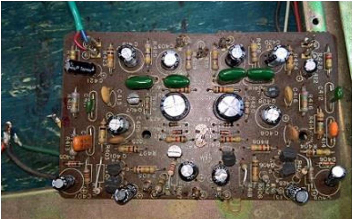
A placa de amplificação estava com algumas gambiarras e com componentes queimados.
