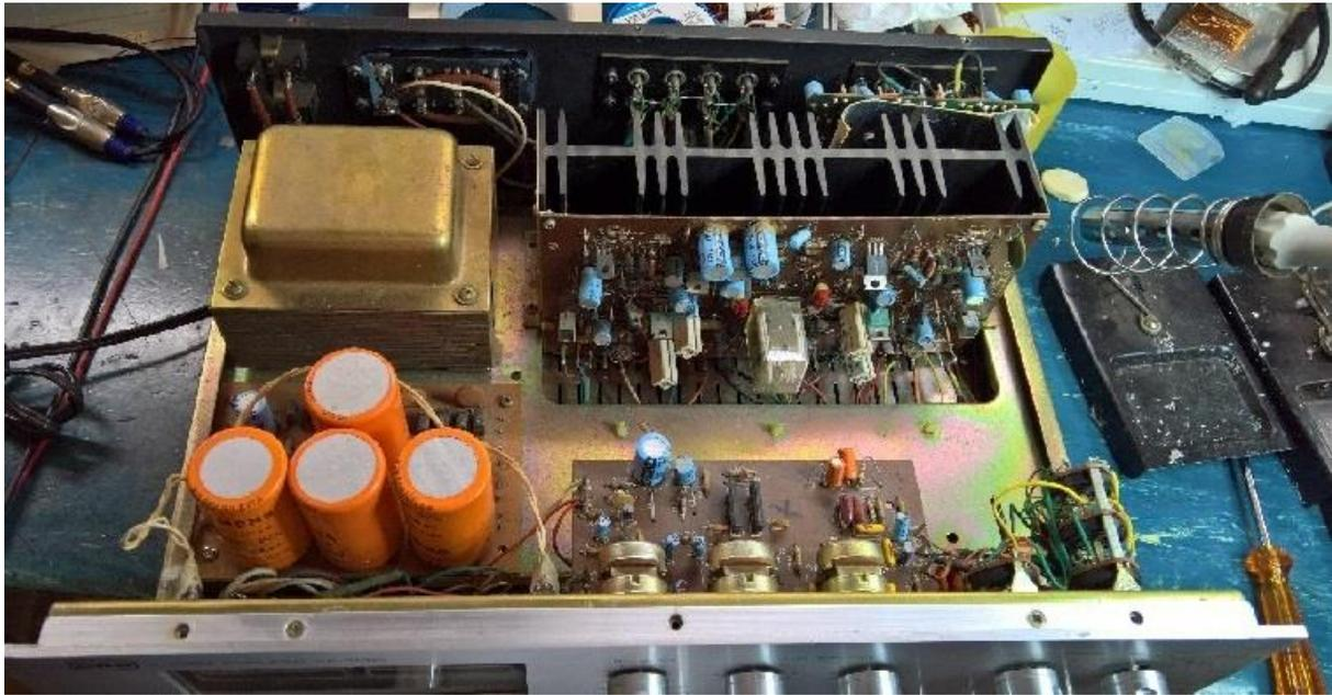
Iniciando com a fonte de alimentação, descobri que o termo “DUAL POWER SUPPLY” no painel frontal do aparelho se refere a duas seções de retificação e filtragem separadas, a partir de dois secundários do transformador de alimentação (adequado para o projeto e muito bem construído, por sinal, com baixas perdas nos testes de carga).
