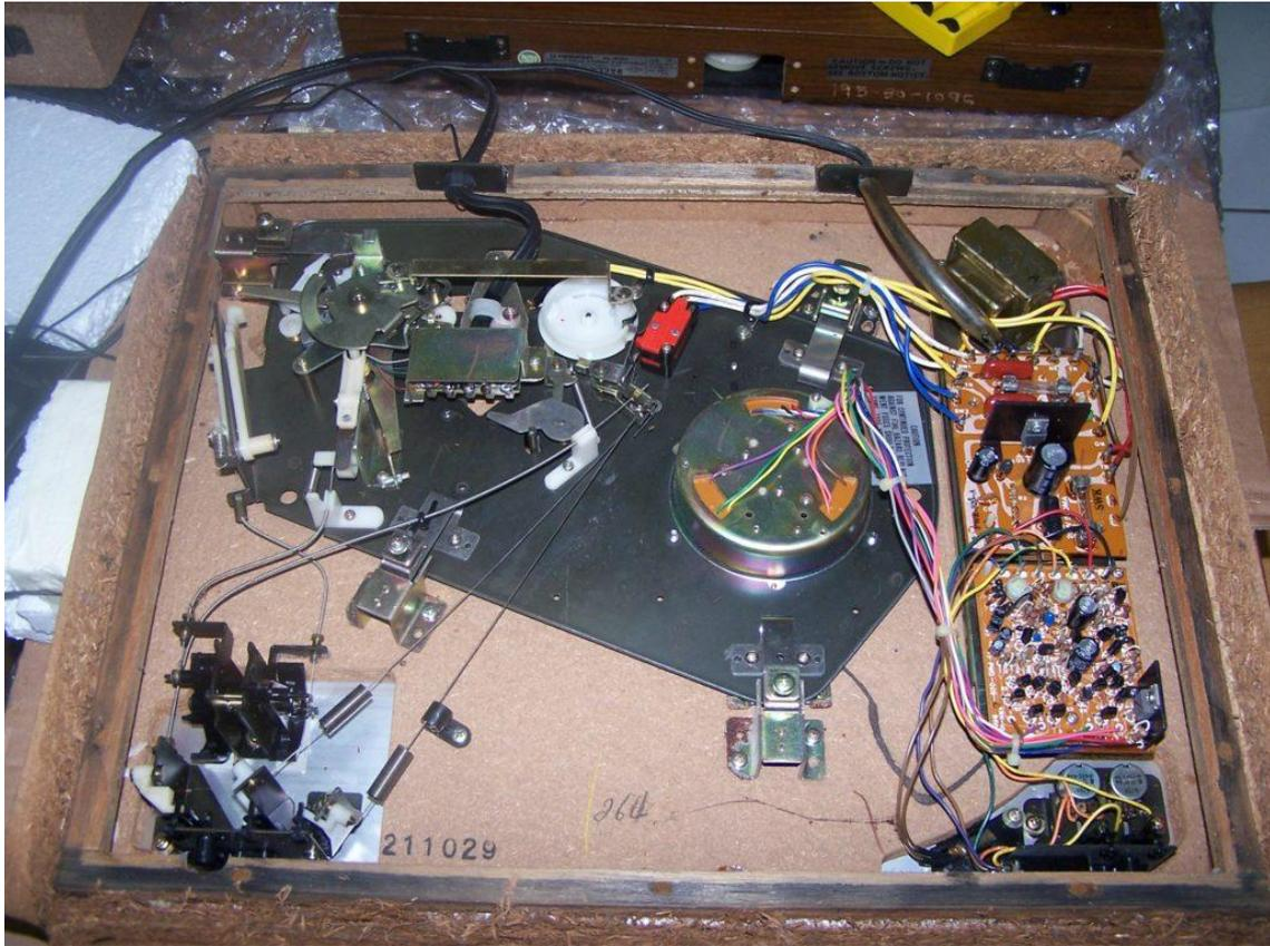
Visão do interior do PL-530 com PCBs, motor, armaduras e demais partes mecânicas
