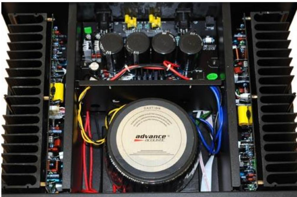
Seu interior mostra uma montagem muito bem feita, cuidadosa, com blindagens isolando os diferentes circuitos eletrônicos e um enorme transformador toroidal, o que indica, a princípio, boa capacidade de fornecimento de energia para seus circuitos de amplificação.
