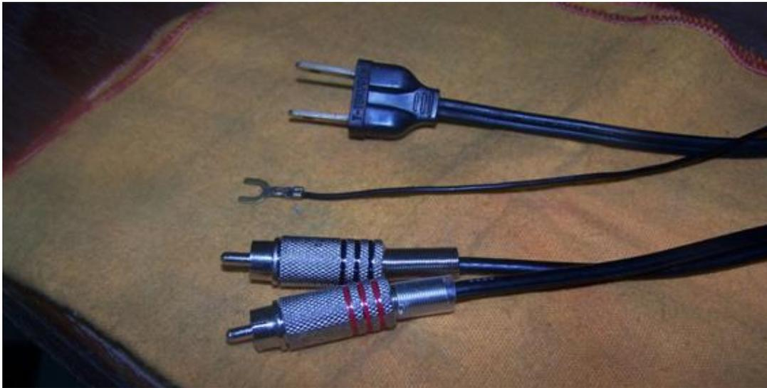
Conectores RCA novos, terminal de aterramento e tomada limpos
