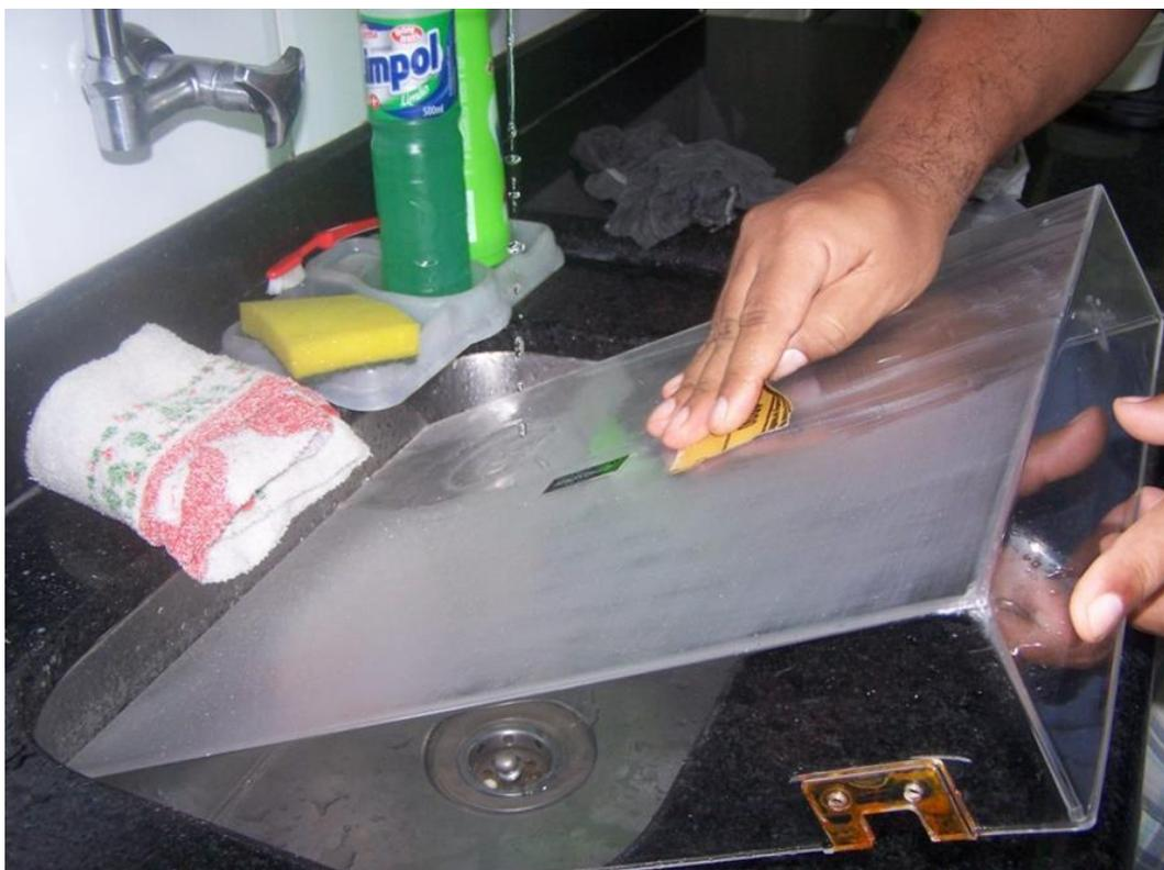
Aplicação das lixas alternadamente, com água corrente
