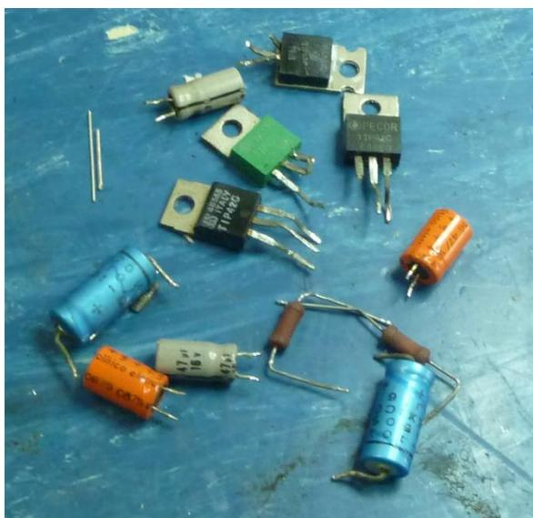
Na correção dos problemas encontramos vários componentes danificados e não originais, aparentemente, em uma das placas de amplificação. Como a outra estava perfeita, inclusive com as soldas originais, nos foi possível restaurar corretamente o circuito, bem como levantar seu diagrama esquemático, que se encontra na última página deste arquivo.
