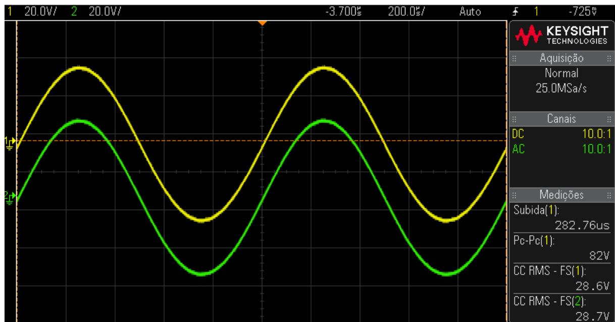
Em 8 $\Omega$ , com ambos os canais em carga, a 1kHz, forneceu 103W no limite do ceifamento
