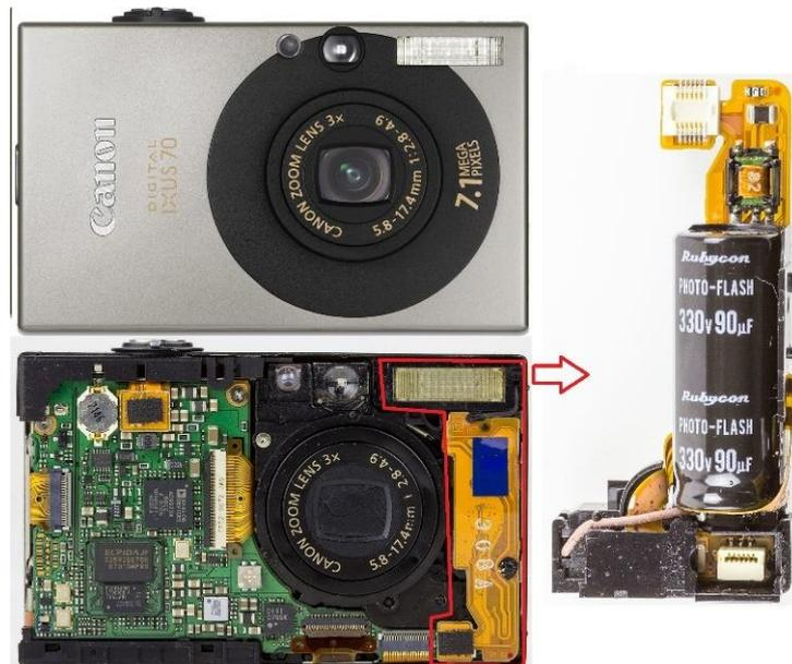
**Figura 1 - Câmera digital Canon IXUS70 e seu capacitor do flash.**
