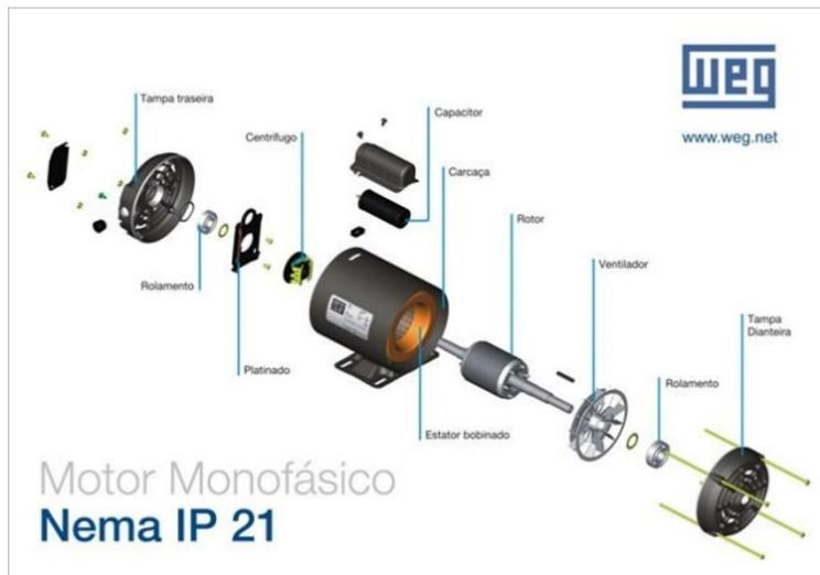
**Figura 7 – Estrutura de um motor monofásico.**
