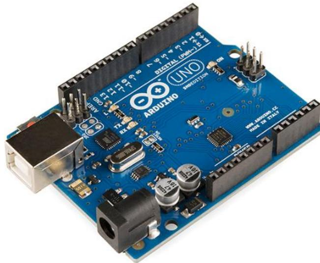
**Fig.1:** O Arduino modelo UNO. Note as duas fileiras laterais com as portas de entradas e saídas.
