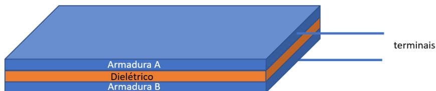
Figura 2 – Capacitor de placas paralelas.
