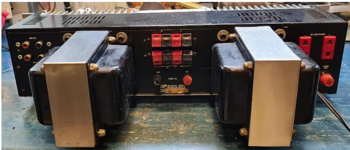
O painel traseiro tem o necessário para sua operação e, adicionalmente, oferece tomadas de rede elétrica não comutadas e saída de baixo nível para medidores de VU.
