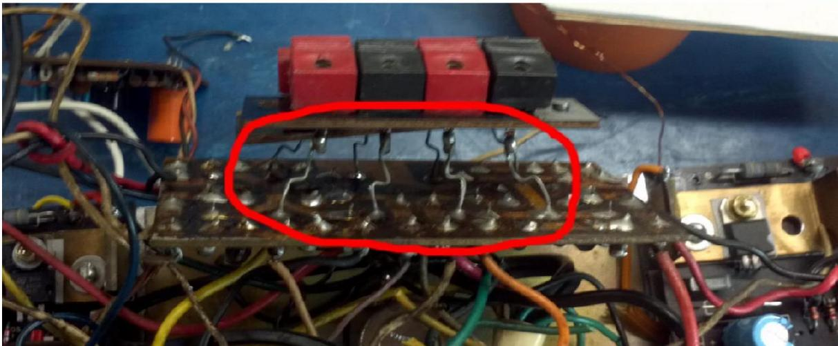
Os circuitos de amplificação também mostravam danos e alguma manutenção efetuada, com marcas de derretimento e carbonização em componentes.
