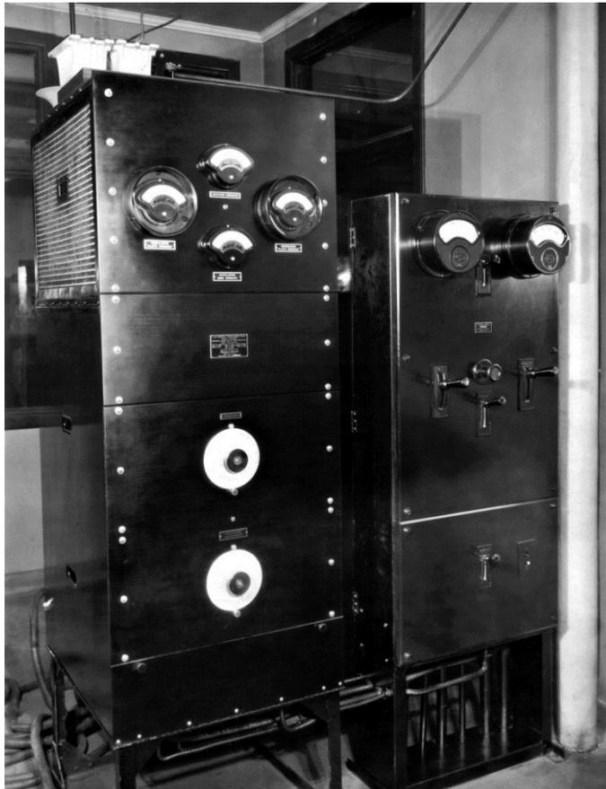
**Transmissor Western Electric 1-A de 500W, que foi o primeiro transmissor para broadcast de fabricação comercial americano. O gabinete da direita controla o motor-gerador que fornece tensão DC para o transmissor. Foto: <http://www.theradiohistorian.org/transmitters/wwj.jpg>**
