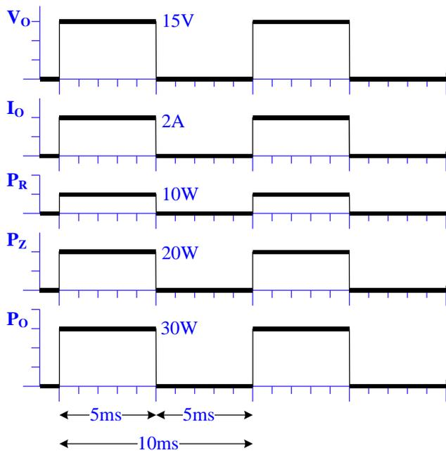
$f = 100\text{Hz}$     $T = 10\text{ms}$     $t_p = 5\text{ms}$     $d = 0,5$
