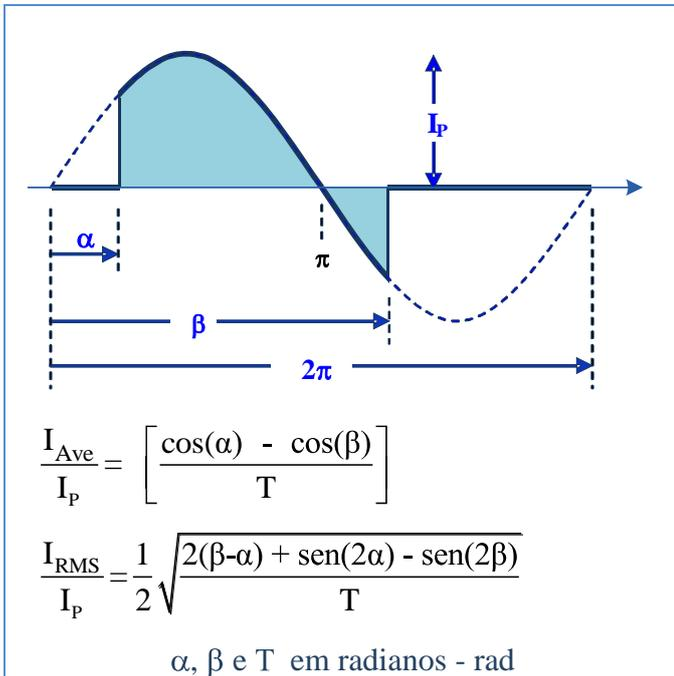
Figura 14- Onda senoidal
