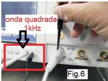
O ajuste deve ser feito com uma chave não metálica, geralmente fornecida junto com a **ponteira** a qual **deverá estar na posição x10**.
