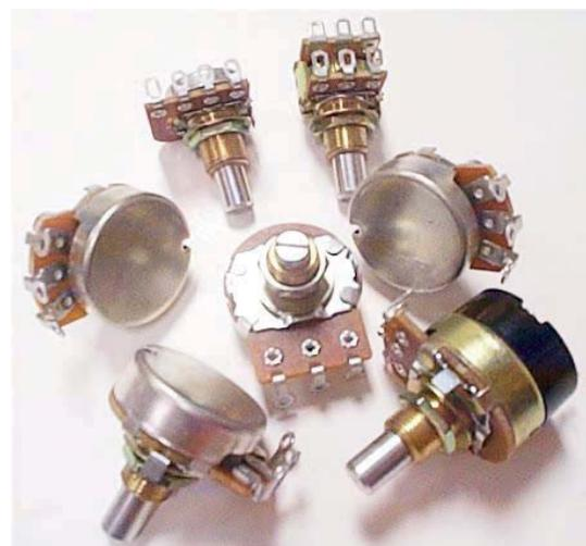
Fig. 7 - Alguns tipos de potenciômetros
