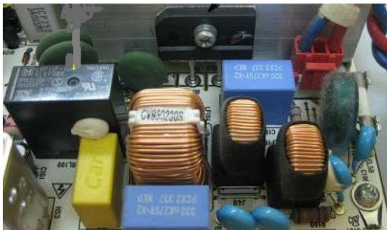
Figura 2- Exemplo do circuito de uma fonte
