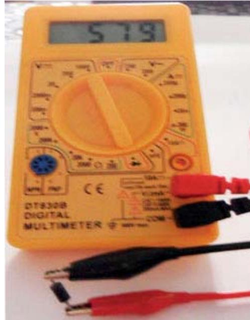
Fig. 7a- Diodo polarizado diretamente
