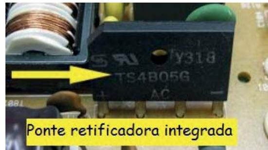
Fig. 17- Ponte retificadora integrada
