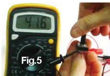
A seguir variamos lentamente o eixo e observamos a resistência no *display* que deverá ir de zero ohm (ou próximo) até o valor máximo do potenciômetro que você já havia medido anteriormente.
