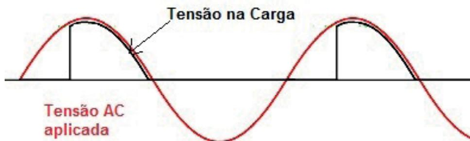
Fig.6 - Formas de onda no circuito com SCR
