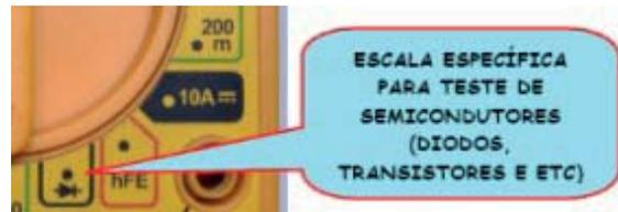
Fig. 18 - Função usada para testar diodos e transistores
