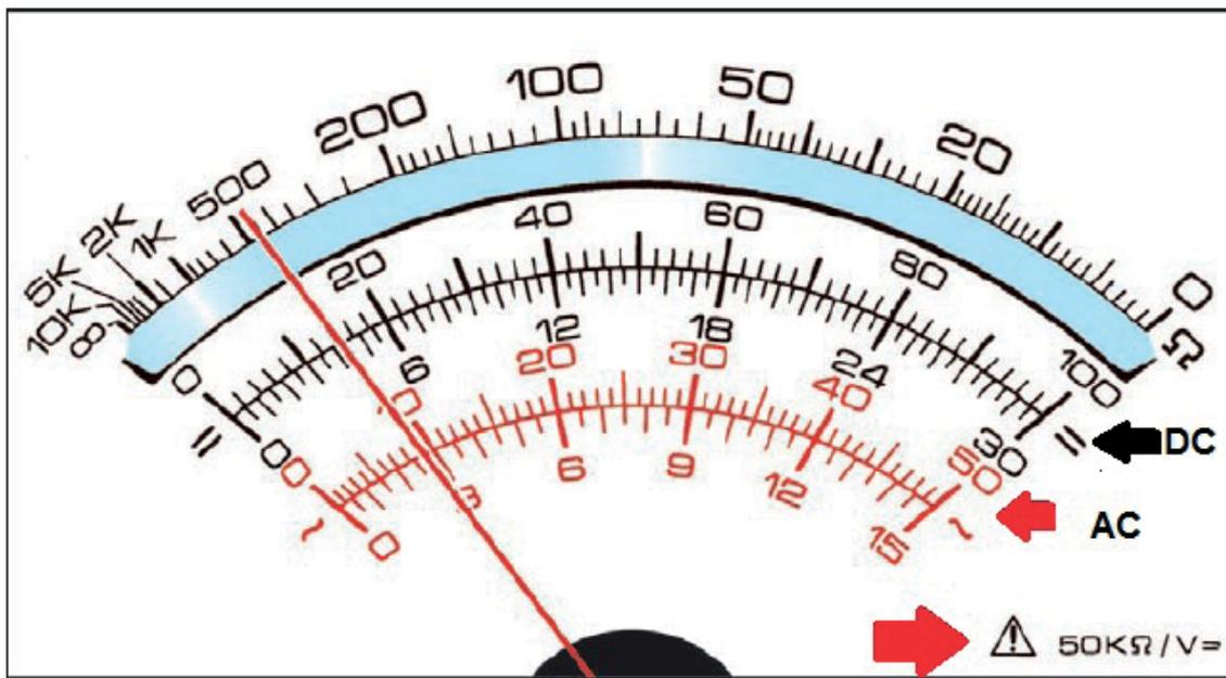
Fig.10 - Painel de um multímetro analógico
