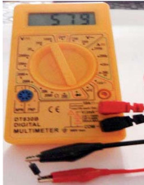
Fig. 7a- Diodo polarizado diretamente
