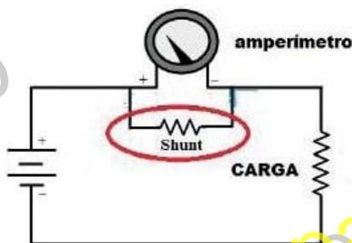
Fig.5 - Shunt para medir corrente
