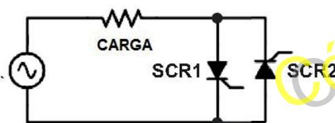
Fig.7 - Dois SCR's em anti-paralelo
