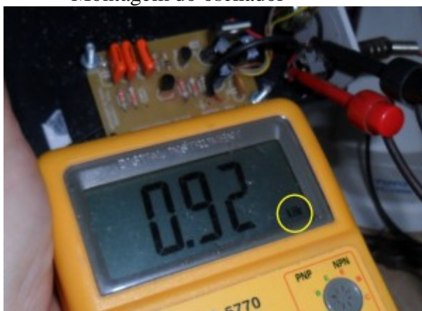
Medindo a frequência do oscilador
