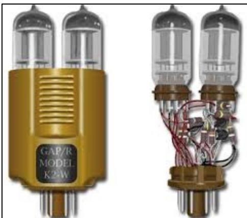
Amplificador operacional valvulado
