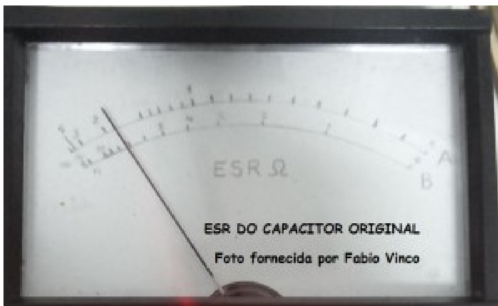
ESR do capacitor defeituoso
