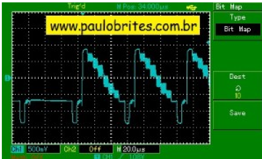
sinal composto de vídeo num osciloscópio digital
