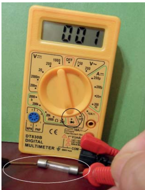
Fig. 7 - Testando um fusível de vidro bom
